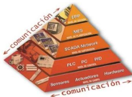
**Figura 3.** Estructura de la pirámide de automatización.
