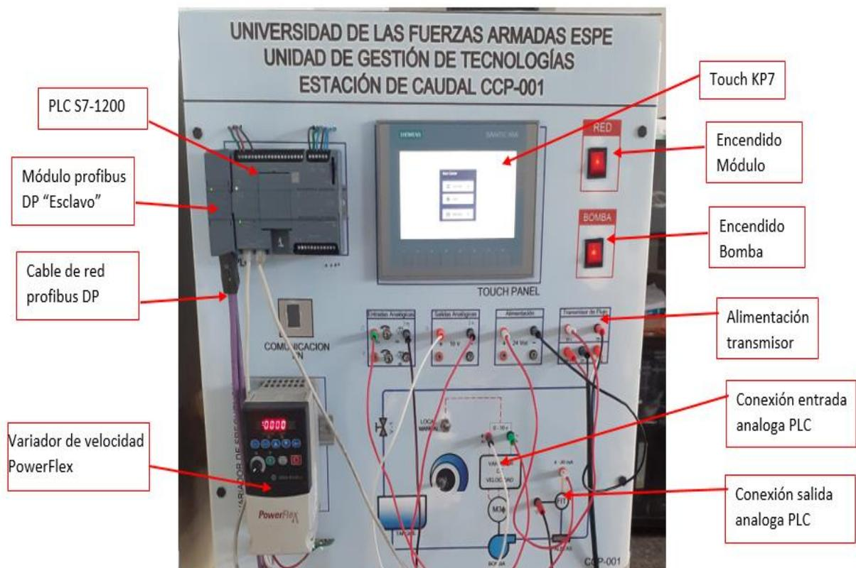
**Figura 14.** Conexiones estación caudal CCP-001.
