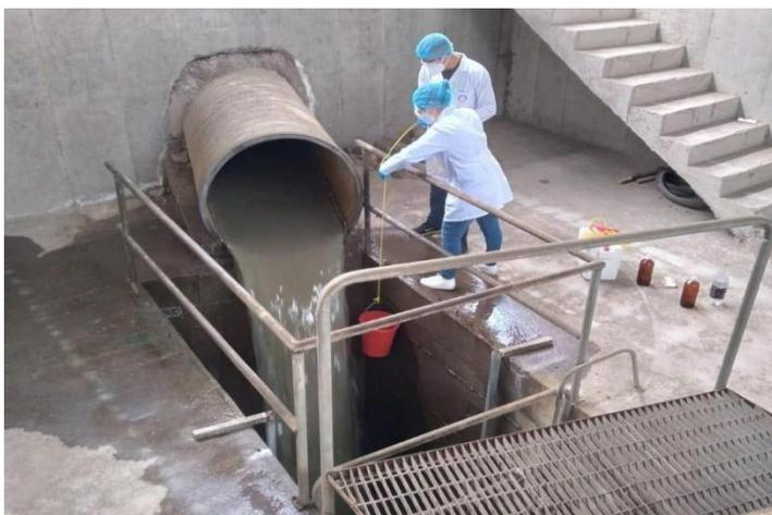
*Nota:* El gráfico muestra la recolección de las muestras de aguas residuales en el colector correspondiente para analizar en laboratorio.
