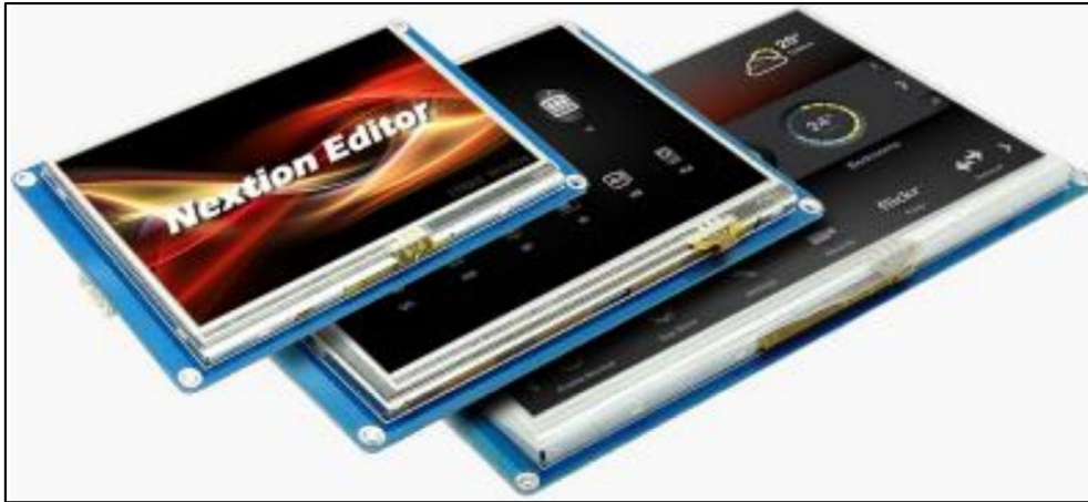
Figura 8. Pantalla Nextion de Diferentes Tamaños
