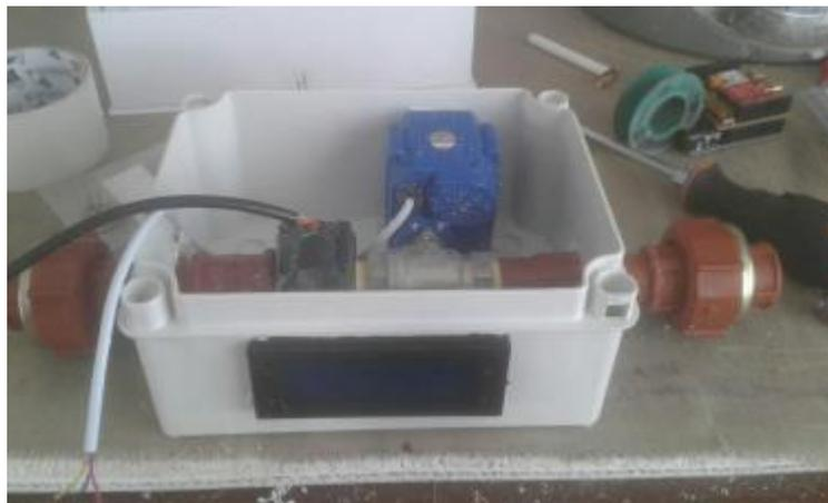
Como siguiente paso se colocaron los elementos electrónicos restantes como el Arduino UNO y su shield LoRa, el relé, el circuito de reloj y la batería de respaldo para dotar de
