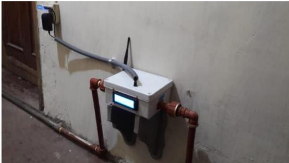
Al mismo tiempo se debe ubicar el gateway LoRa con línea de vista con el sistema de control y consumo. Para el gateway se debe asegurar una fuente de alimentación continua de energía y salida al Internet, sea esta de forma inalámbrica o alámbrica. Para este proyecto se utilizó una conexión ethernet para la salida al Internet. La Figura 45, muestra la instalación eléctrica del gateway LoRa.
