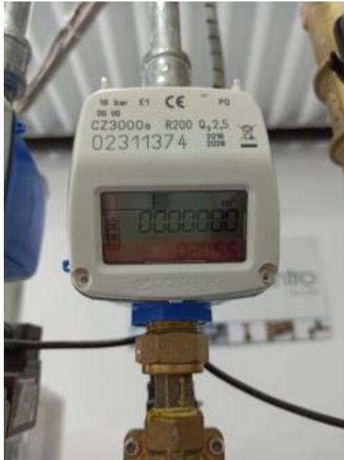
Finalmente se procedió a realizar una prueba con 100 L de agua obteniendo en el prototipo  $0.099\text{m}^3=99\text{L}$ , esto se puede observar en la Figura 37.
