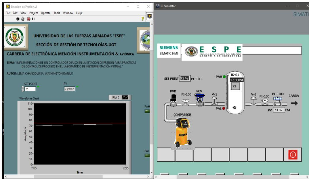
Nota: Representación del control difuso en el HMI elaborado en el Software TÍA PORTAL y LabVIEW. Tomado de *Software TÍA PORTAL y LabVIEW* [Captura].
