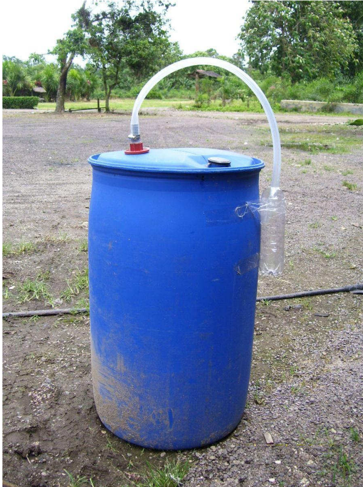
ANEXO AT: Fotografía del tanque biofermentador con todos sus componentes.
