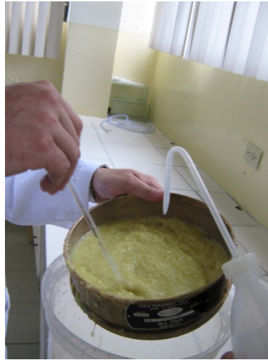
Figura 25: Filtración del mosto a través del tamiz de 600 milimicras.
