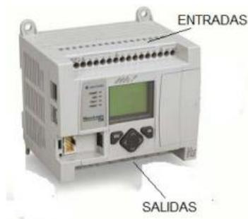
*Nota:* El MicroLogix 1100 cuenta con un panel LCD, tiene 2 entradas analógicas, 10 entradas digitales y 6 salidas digitales.
