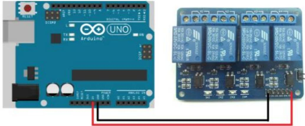
*Nota.* En la figura se observa que el módulo es alimentado por el Arduino. Tomado de (Tolocka, 2015).
