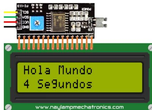
*Nota.* En la figura se puede observar la conexión entre el módulo I2C con la pantalla LCD. Tomado de (Naylamp, 2020).
