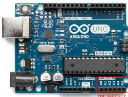
*Nota.* En la figura se observa la ubicación de los pines analógicos en la placa. Tomado de (Ingeniería Mecafenix, 2017).
