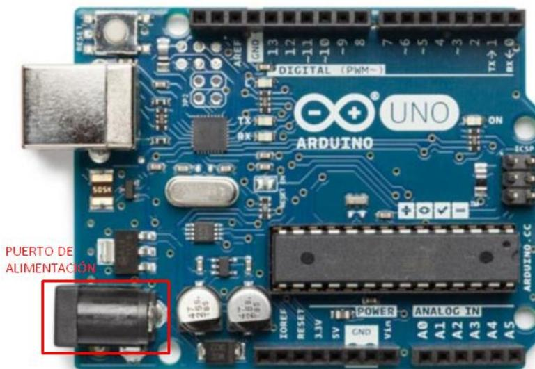
*Nota.* En la figura se observa la ubicación del puerto de alimentación en la placa.
