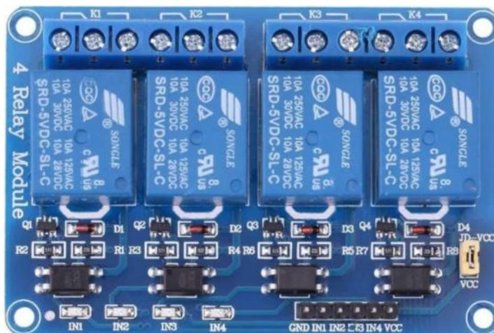
*Nota.* En la figura se observa el módulo de relés de 4 dispositivos. Tomado de (Tolocka, 2015).
