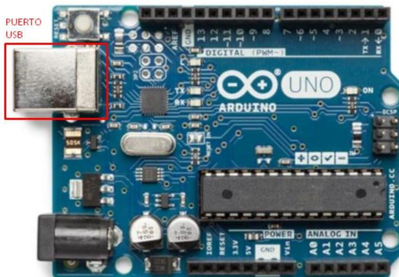
*Nota.* En la figura se observa la ubicación del puerto USB en la placa. Tomado de (Ingeniería Mecafenix, 2017)
