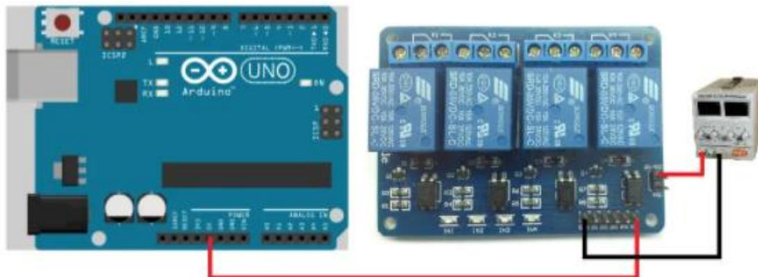
*Nota.* En la figura se observa la alimentación del módulo de relés con fuente externa.
