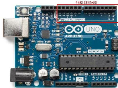
*Nota.* En la figura se observa la ubicación de los pines digitales en la placa. Tomado de (Ingeniería Mecafenix, 2017).
