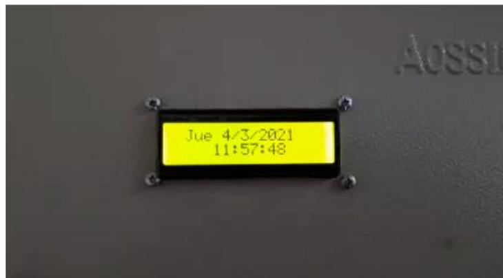
*Nota.* La figura muestra la lectura del módulo RTC del tablero de control.
