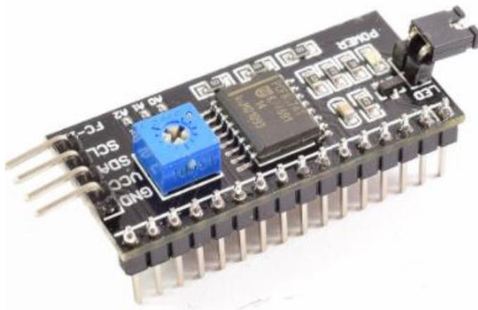
*Nota.* En la figura se puede observar la forma física del módulo I2C. tomado de (Naylamp, 2020)
