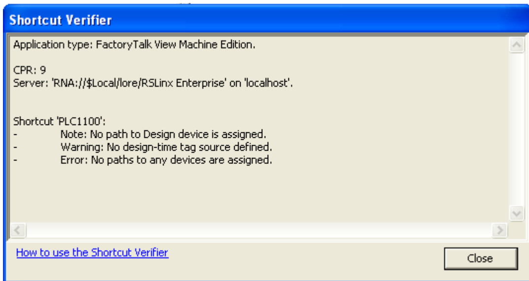
Figura. V. 109. Pantalla de verificación de comunicaciones
