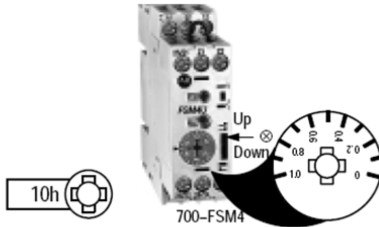
Figura. IV. 7. Selector de tiempo del temporizador Allen Bradley
