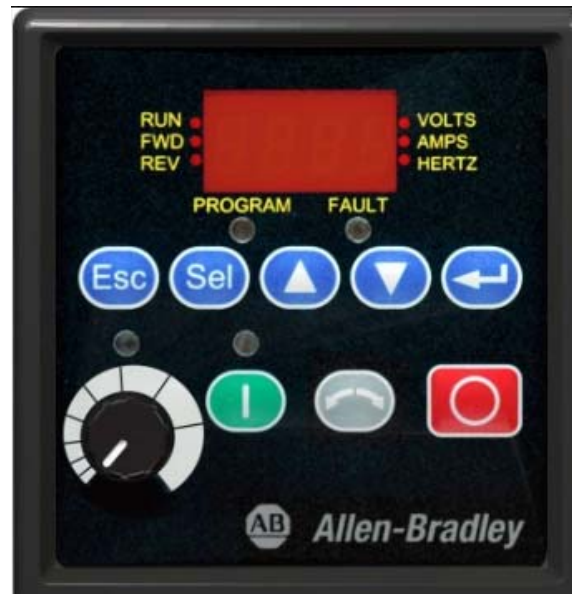
Figura. IV. 24. Pantalla de mando del PowerFlex 4
