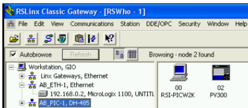
Figura. V. 164. Pantalla principal del RSLinx Classic con el panel conectado.
