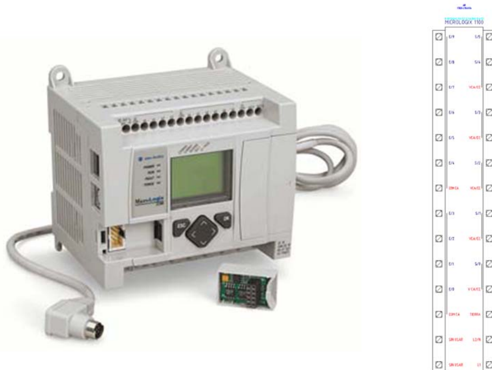
Figura. V. 70. Controlador MicroLogix 1100 y símbolo
