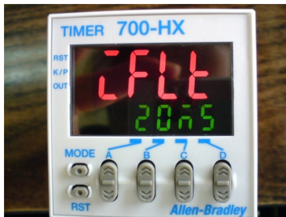
Figura. IV. 16. Timer en función input signal width
