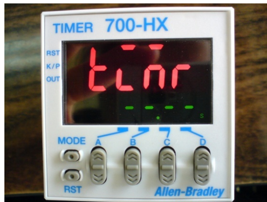
Figura. IV. 12. Timer en función time range
