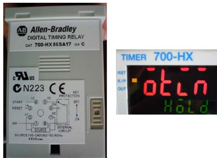
Figura. IV. 10. Tecla de protección del timer relé Allen Bradley
