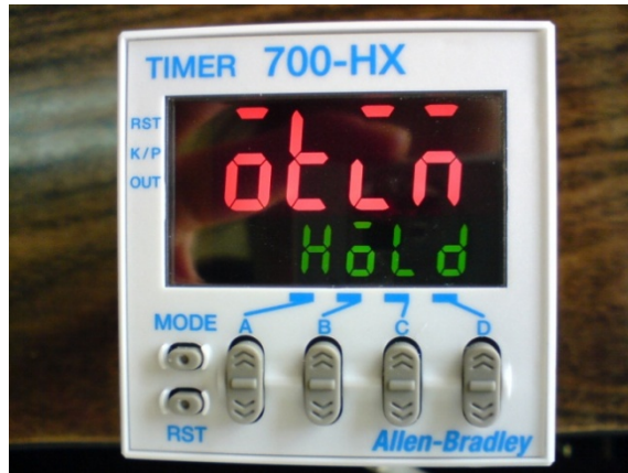
Figura. IV. 15. Timer en función output time
