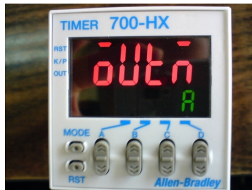
Figura. IV. 14. Timer en función output mode
