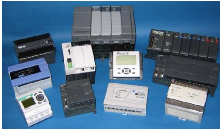
Figura. II. 3. Ejemplos de Controladores Lógicos Programables
