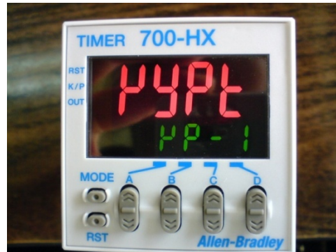
Figura. IV. 17. Timer en función key protect level
