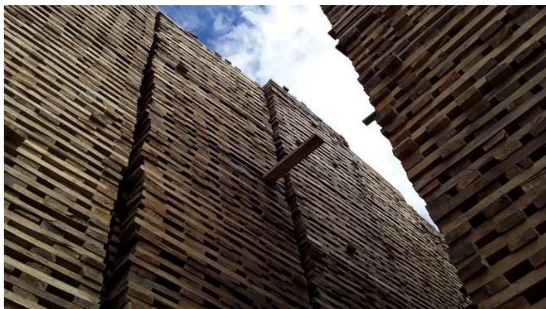
*Nota.* Esta figura muestra al proceso de secado de la madera del Laurel. Imagen tomada en el aserradero “San Martín”.
