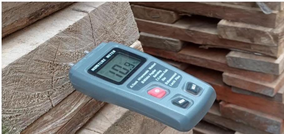
*Nota.* En esta figura se muestra la aplicación del método eléctrico.
