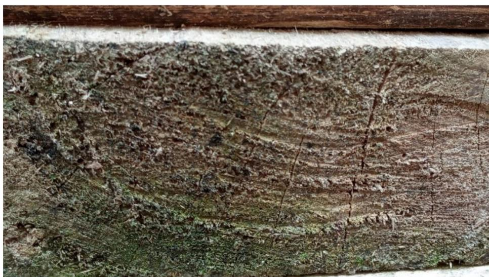
*Nota.* En esta imagen se observa la muestra utilizada en la prueba número 12 la cual arroja un resultado incorrecto a causa de la existencia de moho.
