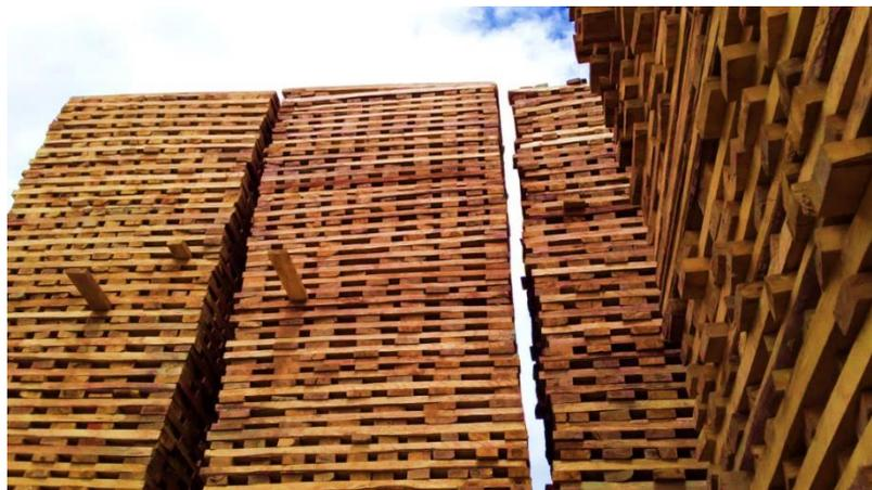
*Nota:* En esta Figura se muestra el proceso de secado de madera aserrada en parrillas, fotografía tomada en el aserradero “San Martín”.
