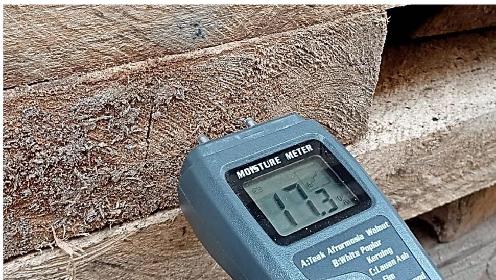
*Nota.* Esta figura muestra la medición de humedad del Laurel utilizando el higrómetro y el método eléctrico.
