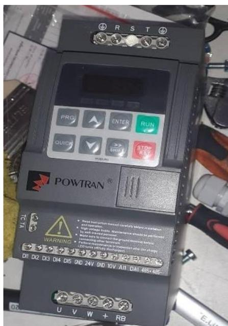
*Nota.* En la figura se muestra el variador de frecuencia POWTRAN adquirido para la elaboración del proyecto
