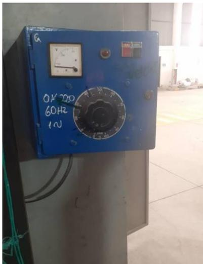
*Nota.* En la figura se muestra el tablero de control que se usaba anteriormente para la manipulación del motor eléctrico antiguo.
