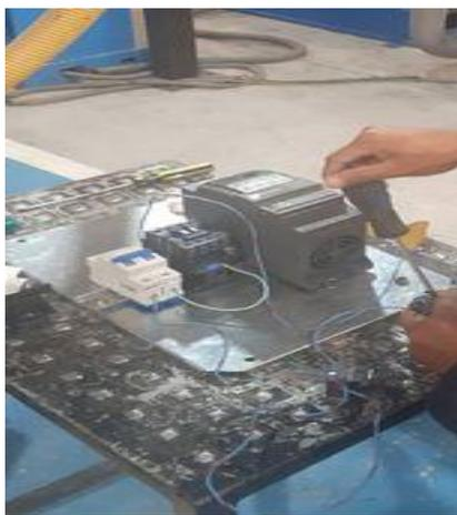
*Nota.* En la figura se muestra cómo se ubicó el variador de frecuencia, contactor e interruptor termomagnético sobre el riel-din que se encuentra en la placa del tablero de control.
