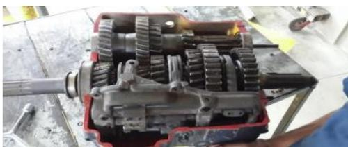
*Nota.* En la figura se muestra que la caja reductora de engranes helicoidales está compuesta internamente de varios engranajes de distintos tamaños. Tomado de: (Chaves, 2019).
