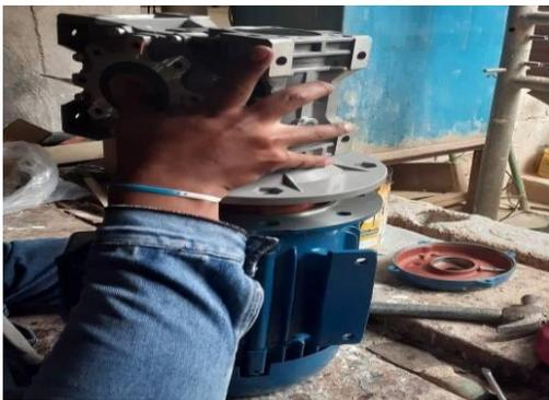
*Nota.* En la figura se muestra cómo se ubica la caja reductora sobre el eje del motor eléctrico.
