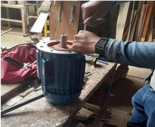
*Nota.* En la figura se muestra el motor eléctrico después de haber retirado la tapa delantera.
