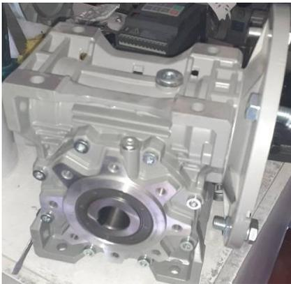
*Nota.* En la figura se muestra la caja reductora sinfín corona adquirida para la elaboración del proyecto.
