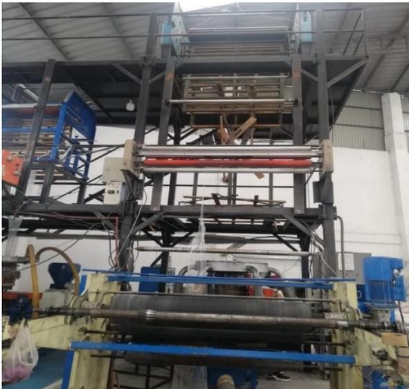
*Nota.* En la figura se puede apreciar la torre en cuya cima se encuentra ubicado el motorreductor junto con los rodillos de tiraje.
