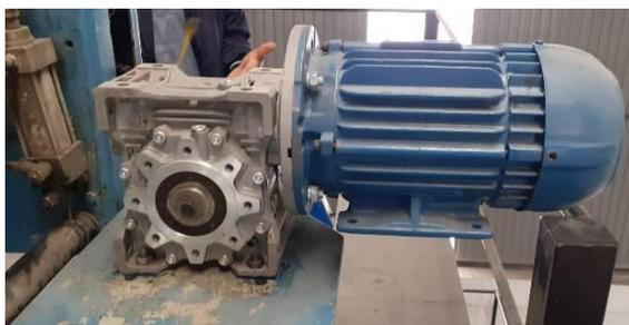
*Nota.* En la figura se muestra el motorreductor ya asegurado a la estructura mediante los pernos correspondientes.
