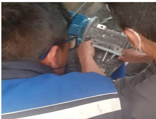
*Nota.* En la figura se muestra el instante en que se tomaron las medidas de distancia existentes entre cada uno de los agujeros de la caja reductora usando un pie de rey.
