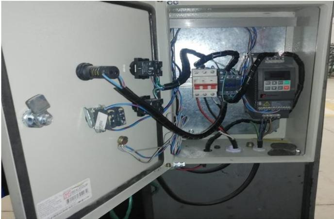
*Nota.* En la figura se muestra cómo se realiza la conexión entre los pulsadores, piloto, selector y los elementos del interior del tablero como lo son el interruptor termomagnético, contactor y variador de frecuencia.
