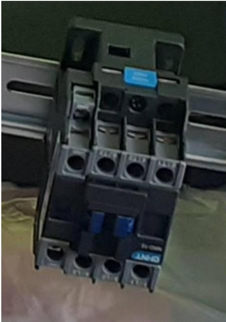
*Nota.* En la figura se muestra el contactor marca CHINT adquirido para la elaboración del proyecto.
