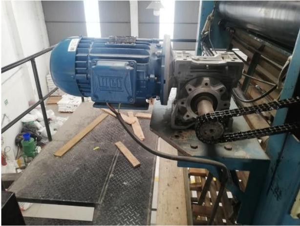
*Nota.* En la figura se muestra cómo se acopló la caja reductora al motor eléctrico mediante pernos.
