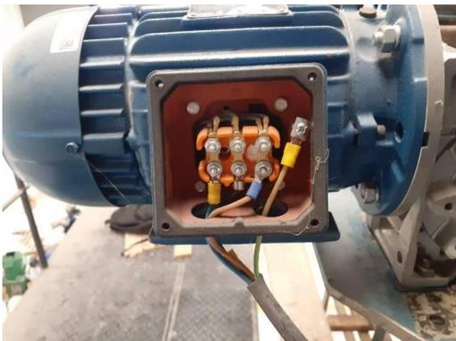
*Nota.* En la figura se muestra la conexión en triángulo que se realizó con los bornes del motor.
