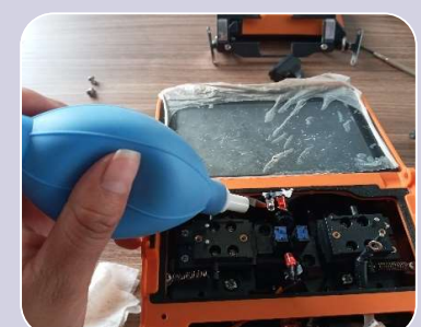
Limpieza interna de la empalmadora
