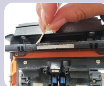
Limpieza del horno calefactor
