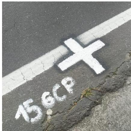
Estos puntos de referencia se fotografían desde el aire y establecen coordenadas precisas para la corrección del modelo, deben ser visibles claramente por la cámara del dron a la altura establecida y diferenciarse de los elementos comunes de la superficie a levantar. (Aerial Insights, 2019)
