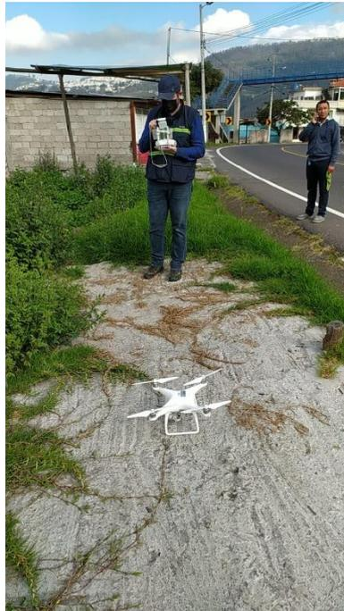
El tipo de vuelo aplicado es malla (grid), un vuelo automático en el que el dron realiza un movimiento longitudinal, a una misma altura, sobre la superficie determinada en la planificación de los vuelos, y que cambia de dirección siguiendo la ruta, como se muestra en la imagen a continuación, hasta regresar al punto de despegue.
