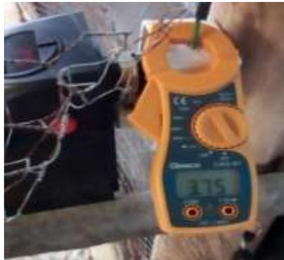
*Nota.* Como se indica en la figura con la ayuda de una pinza amperimétrica podemos observar cual es el consumo de un calefactor eléctrico.
