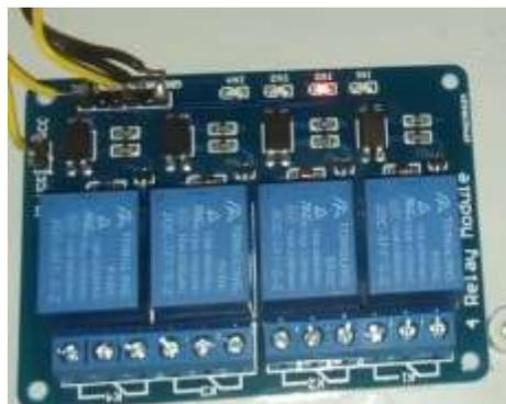
*Nota. En la figura se muestra la conexión de módulo de 4 relés utilizando únicamente dos de ellos para el control de calefactores y ventiladores.*
