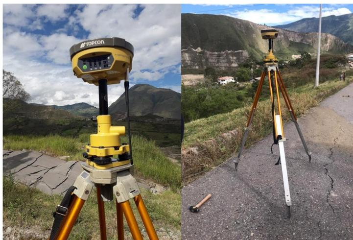
*Nota.* La imagen muestra el GPS Topográfico Topcon Hiper V el cual se utilizó como receptor fijo.
