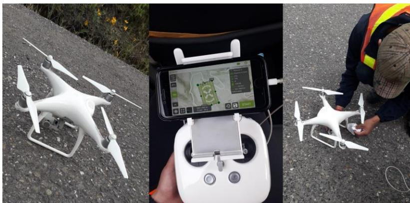
*Nota.* La imagen muestra el Dron Phantom 4 Pro, el control remoto y un aparato electrónico en este caso un teléfono celular con el respectivo el plan de vuelo.
