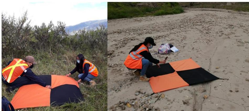
*Nota.* La imagen muestra la colocación de los paineles en los puntos de control y la toma de las coordenadas para posteriormente georreferenciar cada punto con un GPS de precisión.
