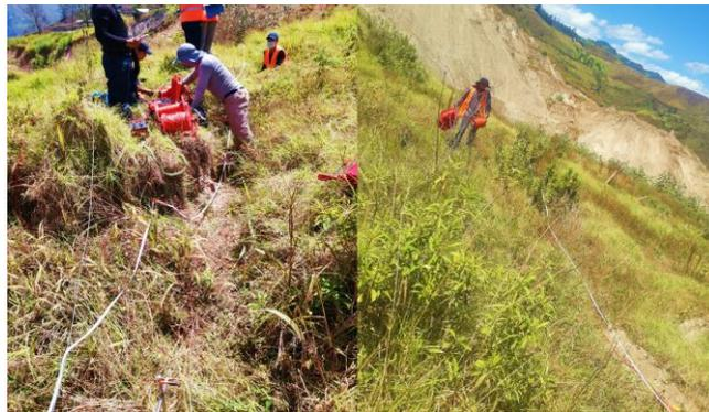
Seguidamente se procede a colocar los electrodos, para ello se debe fijar en el suelo a una distancia conveniente, procurando que tenga una buena conexión del electrodo al suelo. Los electrodos se emplazaron a 1,50 metros entre ellos y sea alejaron a distancias proporcionales cada vez hasta completar los 50 metros que se requería para el ensayo. Se realiza las respectivas conexiones de los electrodos y el equipo de almacenamiento de datos, en este caso al resistivímetro.
