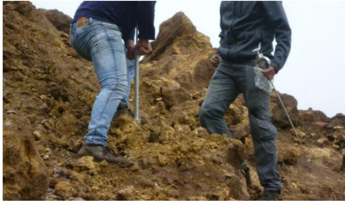
Una vez verificado las conexiones de los equipos y accesorios se inicia con la medición y obtención del valor de la resistencia o el valor de la resistividad directamente, estos datos son captados, obteniendo varios valores a lo largo de la línea de resistividad.
