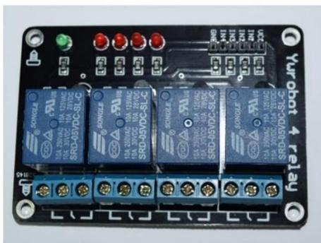
*Nota:* Esta imagen muestra la placa PCB del módulo relay. Tomado de (Morales, 2019)
