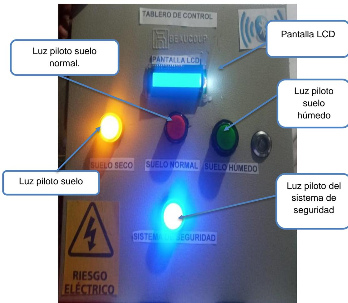
*Nota.* Esta imagen muestra los componentes que tiene en el tablero de control.
