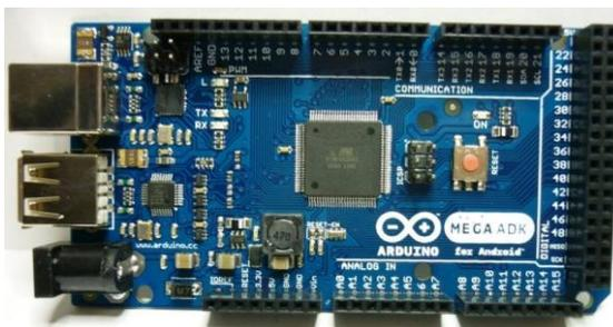
*Nota.* Esta imagen muestra la placa Arduino Mega y sus elementos que componen.
