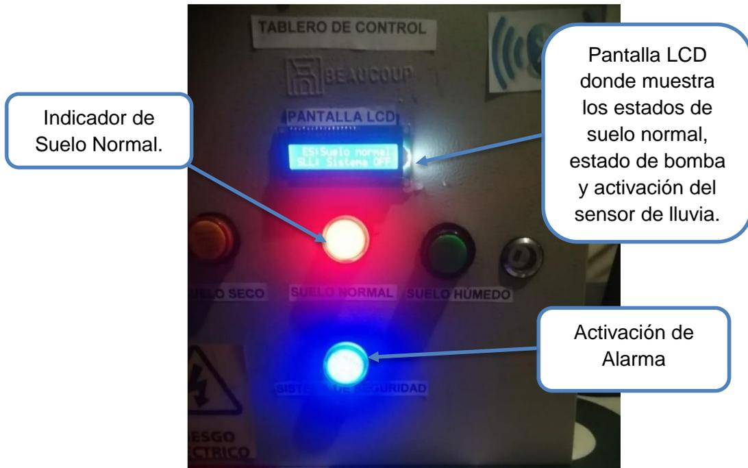
*Nota.* Esta imagen muestra el mensaje del estado normal del suelo y su luz piloto indicadora del estado, además del estado del sensor de lluvia.
