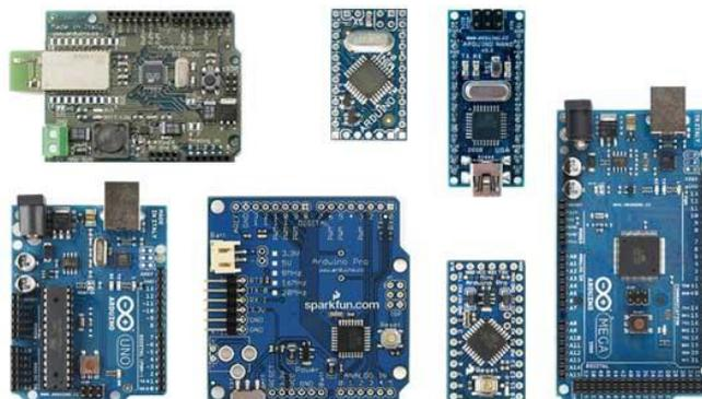
*Nota.* Esta imagen muestra los tipos de Arduino. Tomado de (Oscar, 2009)
