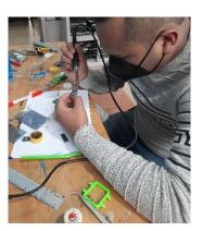
*Nota*. En la siguiente figura se aprecia cómo se está realizando el proceso de soldadura o acople de los alambres a los pines del sensor.
