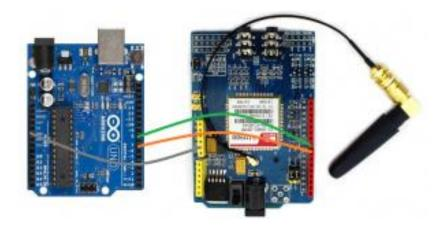
*Nota.* En la figura se puede observar el cableado entre un módulo SIM 900 y una tarjeta de Arduino Uno. Tomado de PROMETEC, *Módulo GSM/GPRS: Llamar y enviar SMS*, 2018.
