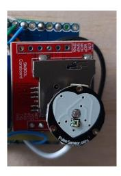
*Nota.* En la presente figura se aprecia el acople del sensor al diseño final del sistema electrónico del prototipo.
