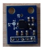
*Nota*. En la figura podemos observar el acelerómetro ADXL – 335, el cual posee 3 ejes analógicos para la obtención de datos de coordenada.
