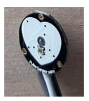
*Nota*. En la siguiente figura observamos un sensor de pulsos cardiacos, el cual posee una salida analógica.
