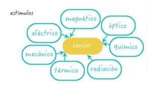
*Nota.* La siguiente figura muestra un esquema de los diferentes tipos de sensores que existen. Tomado de Guimeráns, 2018.
