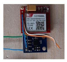
*Nota*. En la presente figura se puede apreciar el módulo SIM listo para ser acoplado a los pines de la tarjeta de Arduino.
