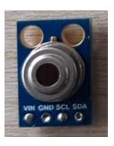
*Nota.* Se puede apreciar en la figura el sensor de temperatura infrarrojo MXL – 90614 el cual trabajo mediante salidas I2C.
