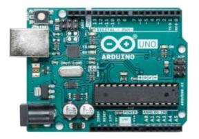
*Nota*. En la figura se puede apreciar una placa de Arduino Uno que posee un microcontrolador re-programable. Tomado de Arduino.cl, 2019.
