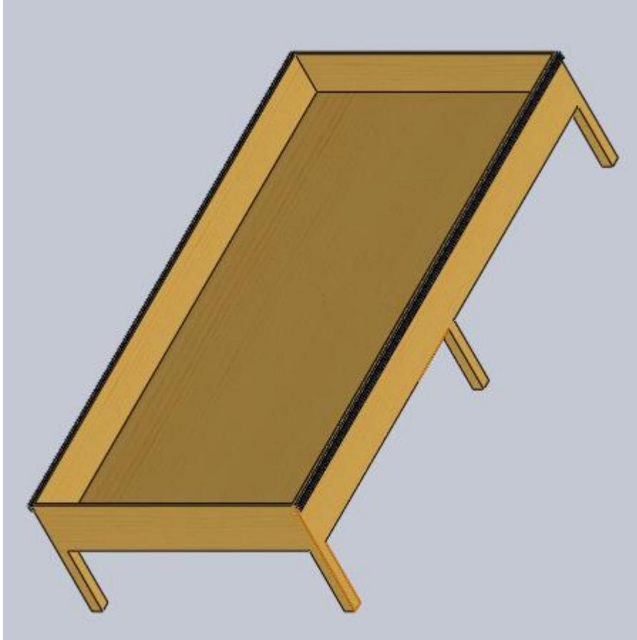
Caja con perfiles del eje longitudinal con dimensión de 20mm x 40mm x 3000mm, en esta caja se va a los elementos como tierra, la siembra y en los perfiles del eje longitudinal estarán perfiles como: superior y transversal con el carro del eje
