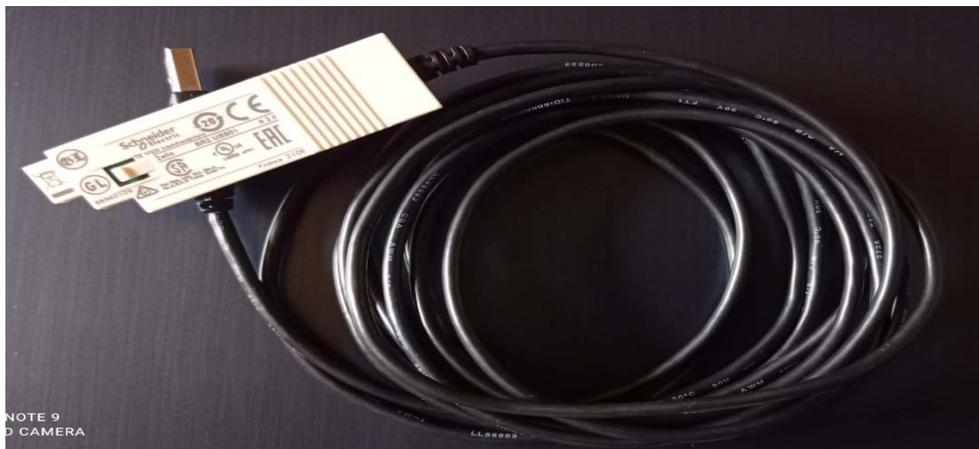
*Nota.* En esta imagen se muestra el cable físico SR2 USB01.
