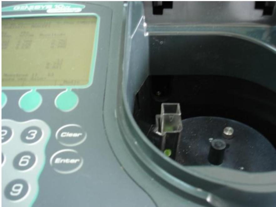
**Figura 2.4 Método de Turbidez: Lectura de una muestra en el espectrofotómetro.**
