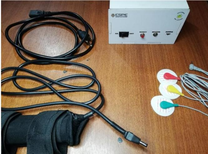
En el presente trabajo se realizó el diseño y desarrollo de un prototipo de banda rehabilitadora con aplicación de terapia como tratamiento para pacientes con esclerosis múltiple. Este proyecto incluyó un sistema de adquisición de datos de actividad muscular, un sistema de actuación de tipo vibratorio a través de motores y una aplicación móvil que controla el funcionamiento íntegro de toda la banda rehabilitadora.
