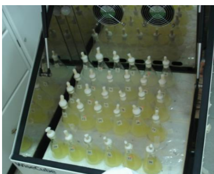
Figura 2.7 Ensayo de biomasa colocada en la Incubadora con agitación Wise Cube.
