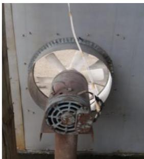
*Nota.* La figura indica la ubicación del motor 3 correspondiente a la salida del logo Q4 y contactor 4.
