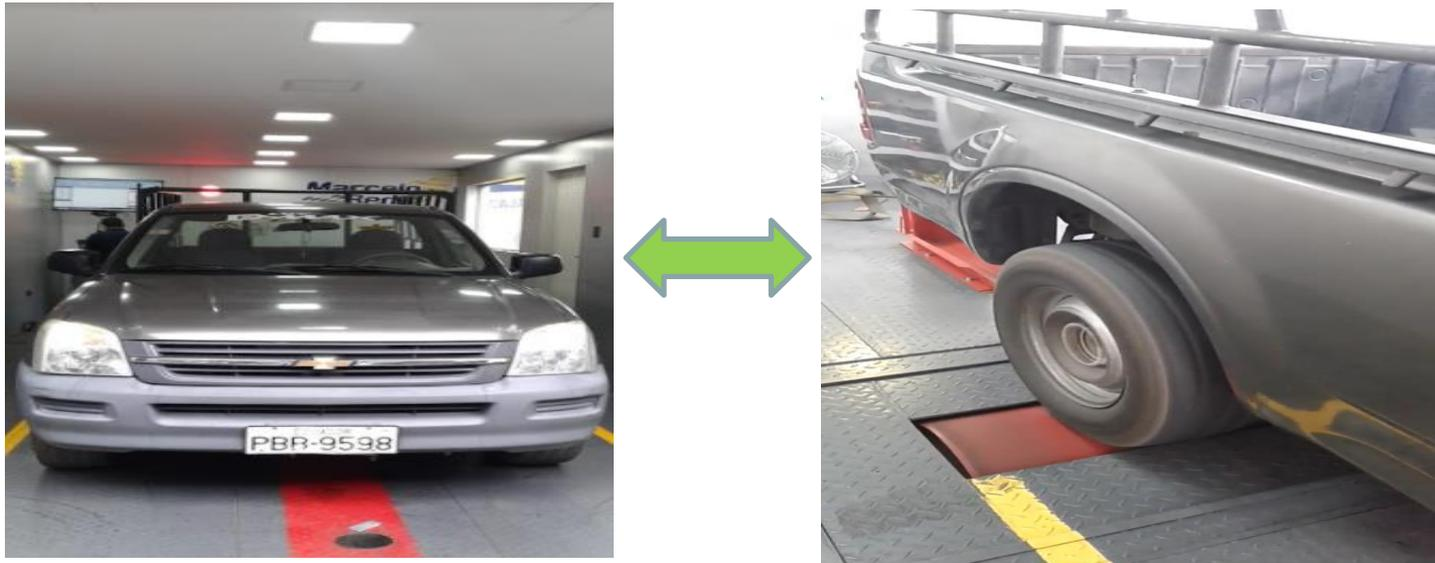
*Figura 6 colocación de las ruedas de tracción sobre el rodillo del banco del dinamómetro*
