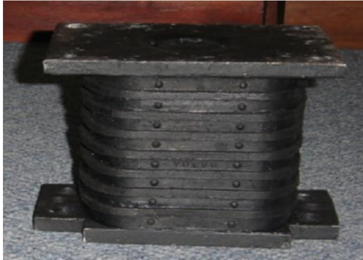
Fig. 7.1. Prototipo con resorte vulcanizado en el núcleo
