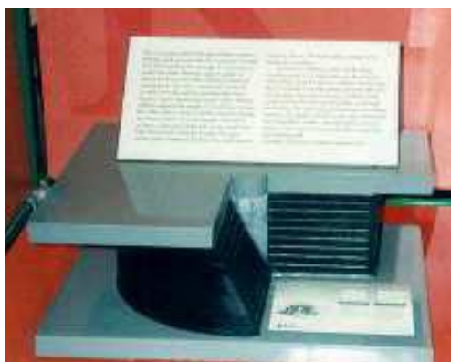
Fig. 2.3 Esquema Aislador Elastomérico. (Desarrollo y fabricación de aisladores sísmicos para Edificio Habitacional)
