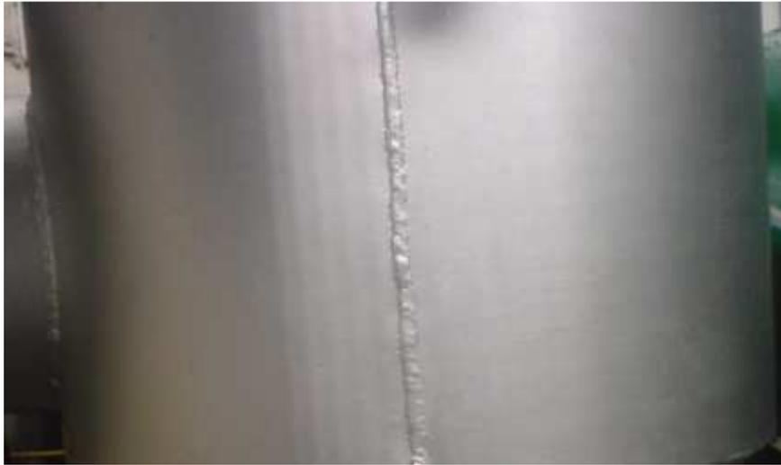
Figura 4.2 cordón de soldadura realizado en la pared del calentador<sup>62</sup>
