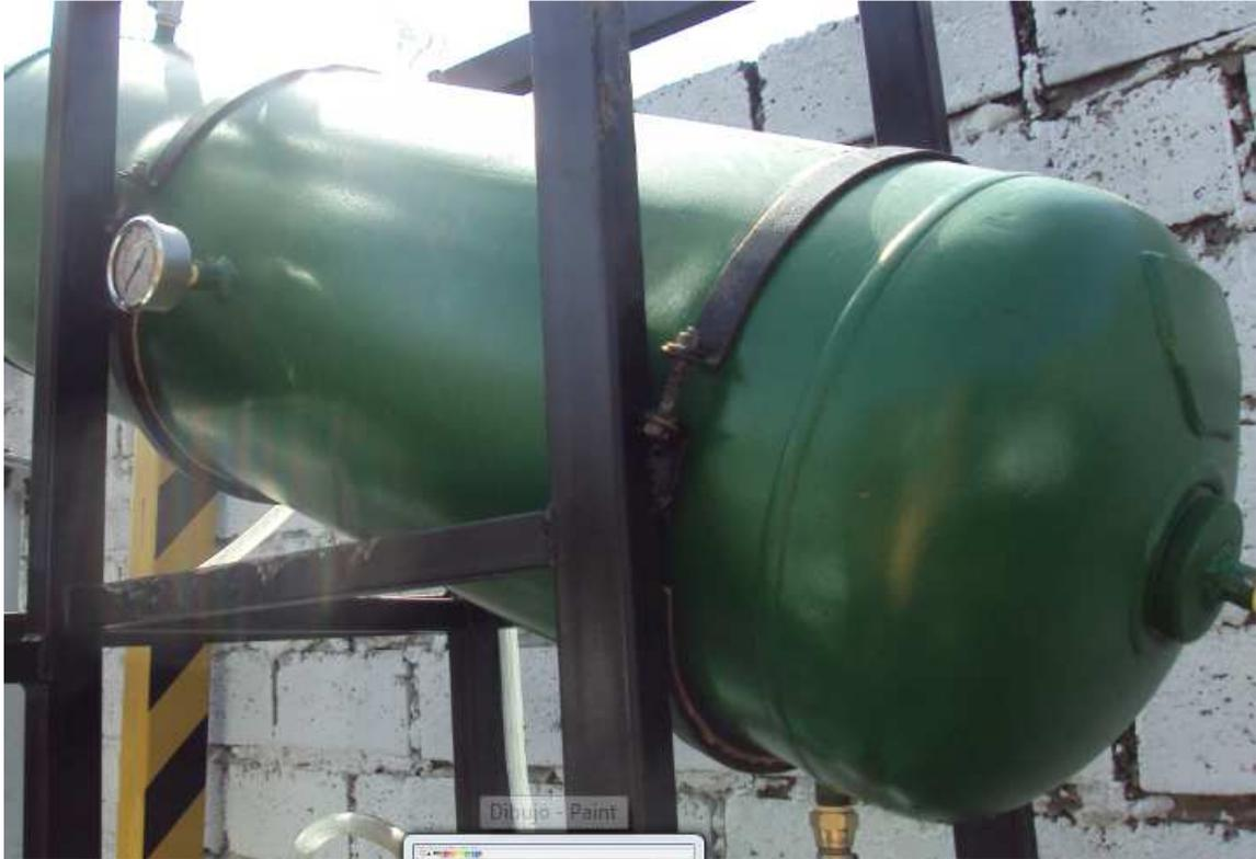
**Figura 4. 19 Manómetro para medir la presión de agua en el condensador de efluentes livianos<sup>73</sup>**
