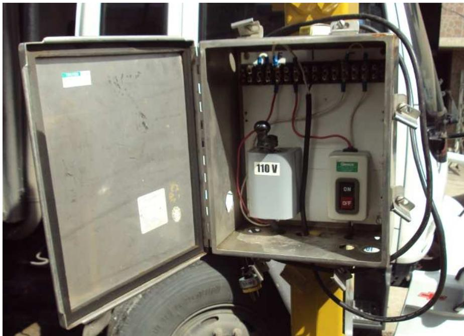
Figura 4.25 Panel de control de la bomba y deflector<sup>79</sup>
