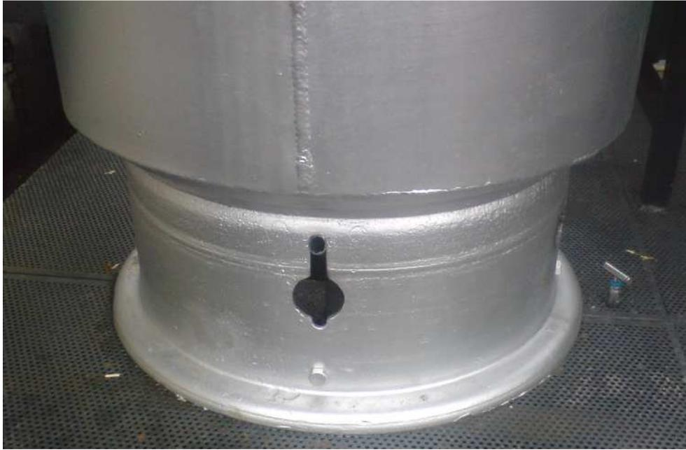
**Figura 4.10 Soldadura de la base del calentador a la base de todo el equipo de destilación<sup>67</sup>**
