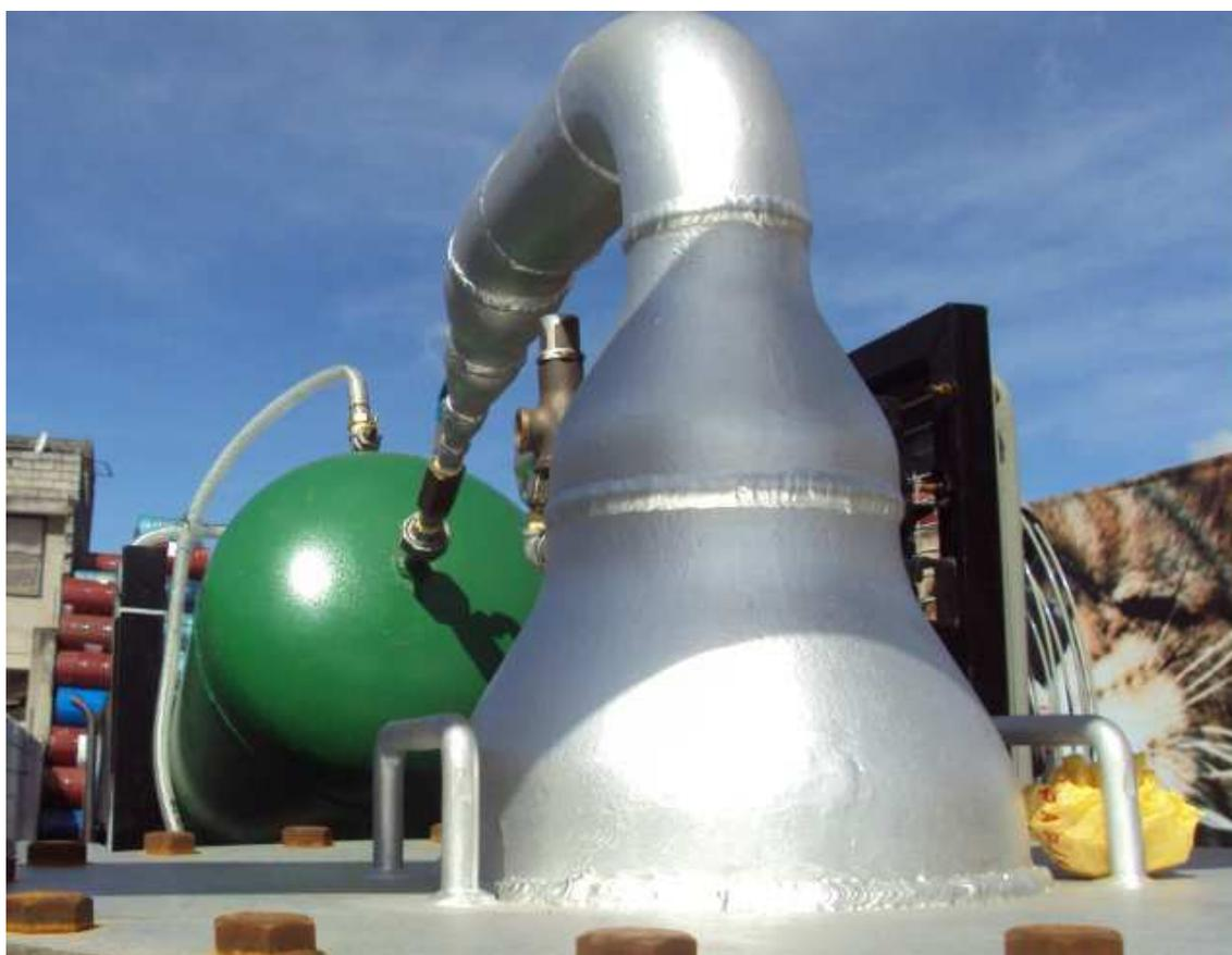
Figura 4. 15 Cabeza hemisférica y conexión con el condensador de efluentes livianos<sup>69</sup>
