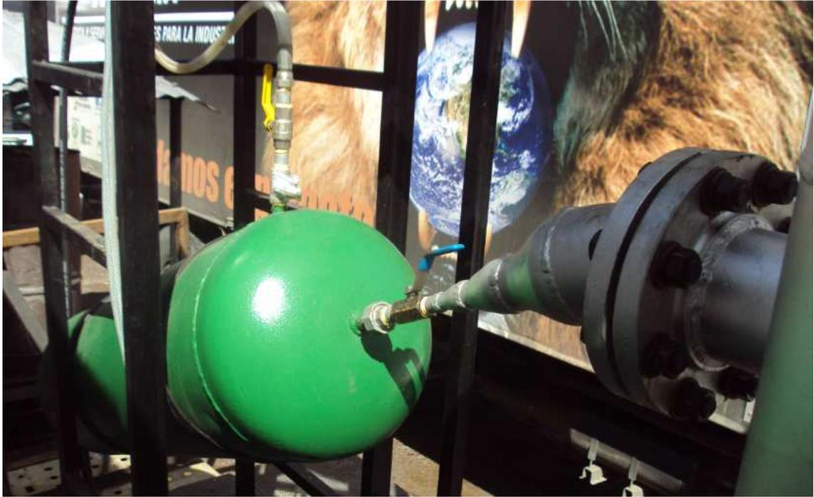
Figura 4. 16 Condensador de efluentes pesados, válvula de paso de gas<sup>70</sup>
