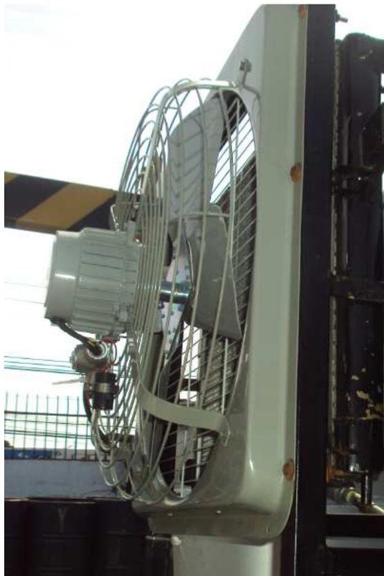
Figura 4.20 Deflector para intercambiador aire-agua<sup>74</sup>
