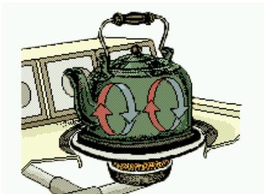
**Figura 2.7 Convección de una superficie a un fluido en movimiento**
