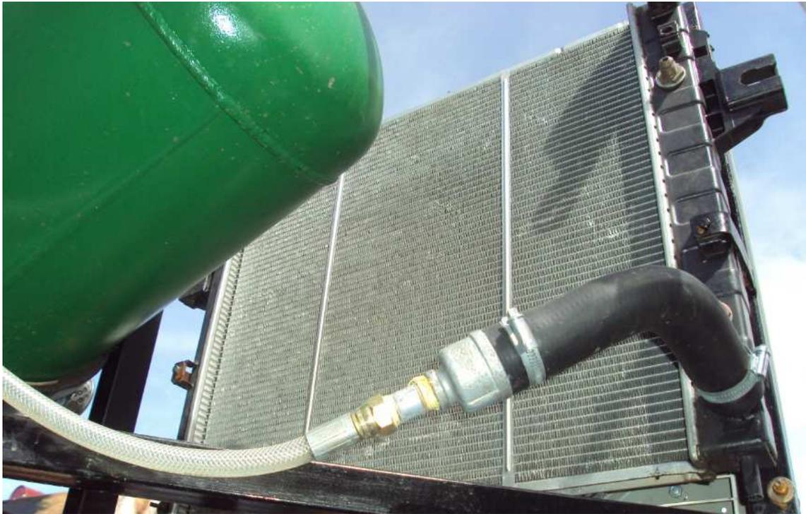
Figura 4.21 Intercambiador aire-agua<sup>75</sup>
