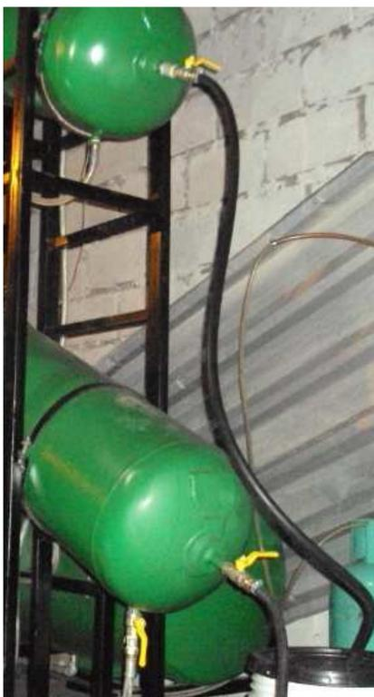
Figura 4.30 Mangueras que transportan el hidrocarburo desde los condensadores a los tanques de recolección<sup>84</sup>
