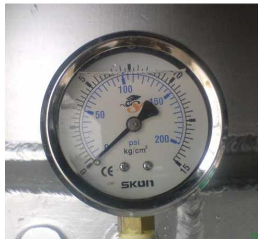
Figura 4.6 Manómetro<sup>64</sup>
