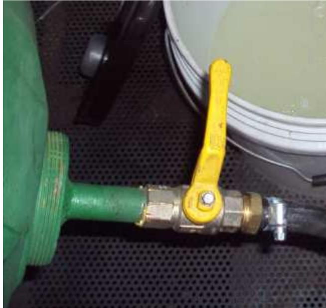
**Figura 4. 18 Válvula de paso del condensado<sup>72</sup>**
