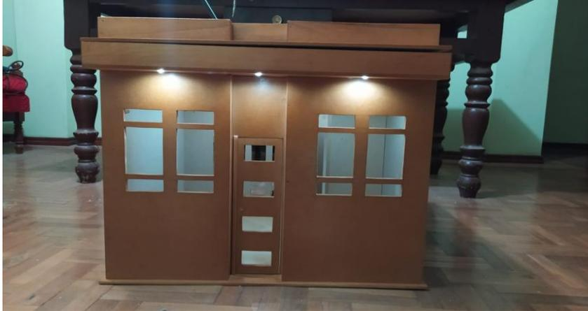
*Nota:* La figura anterior muestra la prueba de funcionamiento de todas las luces encendidas del prototipo domótico con comandos de voz previos.
