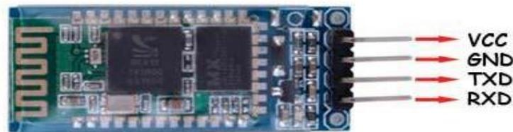
*Nota:* La siguiente figura muestra el módulo bluetooth HC-06 con los nombres de los pines de conexión. Tomada de (El Octavo Bit, 2020)
