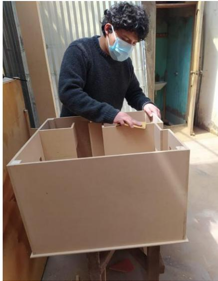
*Nota:* La figura anterior muestra la unión de las paredes con pegamento de madera para formar la estructura de la casa.
