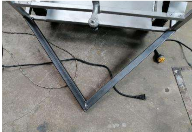
Figura 107 Diseño del triángulo de estabilidad
