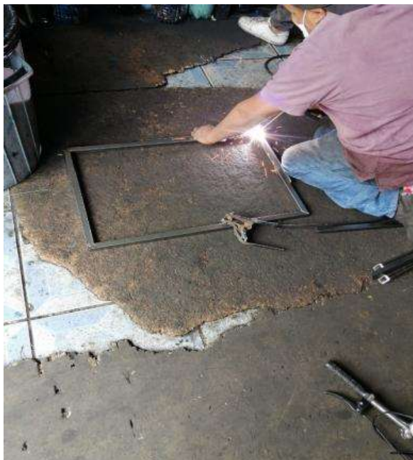
Figura 94 Soldeo de la base del remolque
