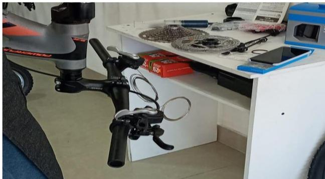
*Nota.* Se puede observar el ajuste correcto del manillar ajustando los pernos de fijación.
