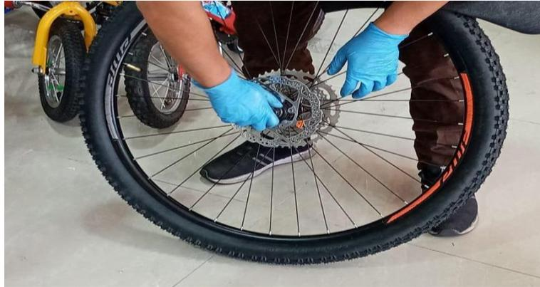
*Nota.* Se puede ver la colocación de los discos de freno en la rueda posterior, así como en la delantera.
