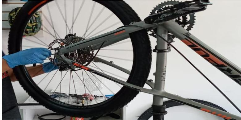
*Nota.* Se observa el ajuste del sistema de freno, el más importante en la seguridad de la bicicleta.
