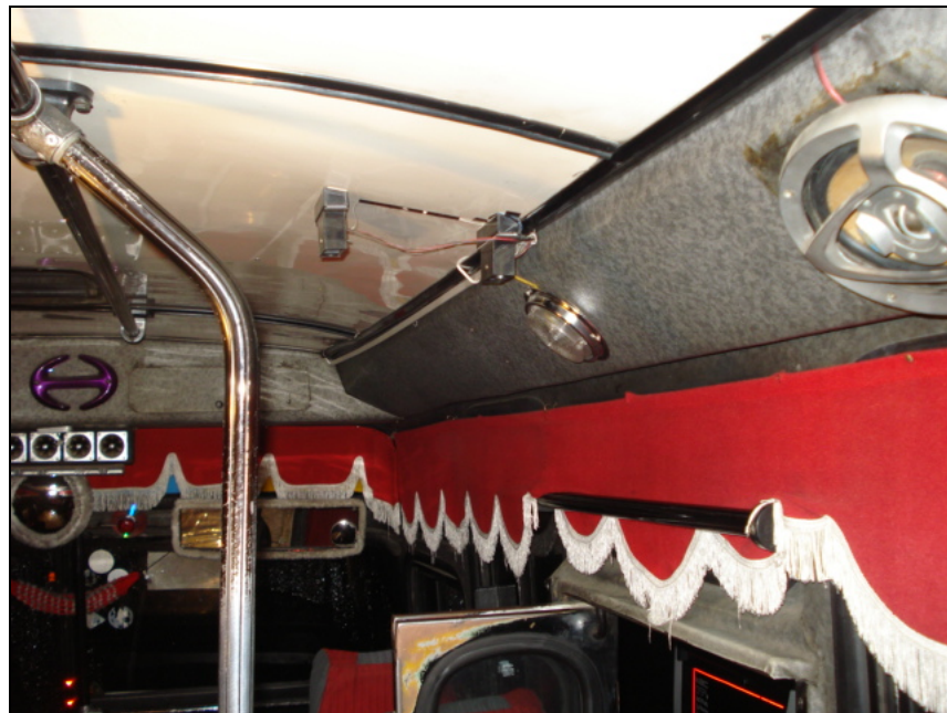
Figura 5.8. Vistas: frontal y lateral de la instalación de los sensores en la unidad de transporte.
