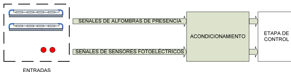
Figura 3.2. Diagrama de bloques de la etapa de instrumentación.
