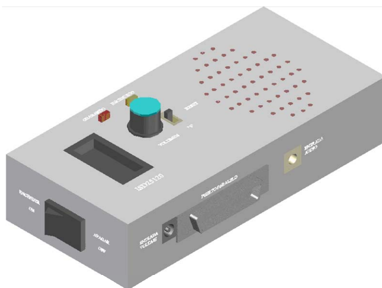
Figura 5.2. Caja del grabador/reproductor de mensajes de voz.
