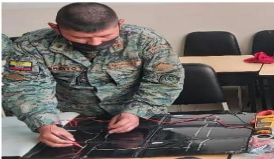
*Nota:* En la siguiente imagen se pudo observar las respectivas mediciones con el multímetro de las conexiones eléctricas realizadas con los paneles solares policristalinos. Tomada de (Job Morales, 2021).
