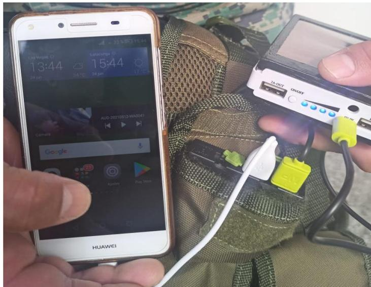
*Nota:* En la siguiente imagen se observa el test de carga con el prototipo de un sistema de carga, con energía fotovoltaica, para proceder a realizar varios test de carga con los dispositivos electrónicos para verificar el funcionamiento. Tomada de (Job Morales, 2021).
