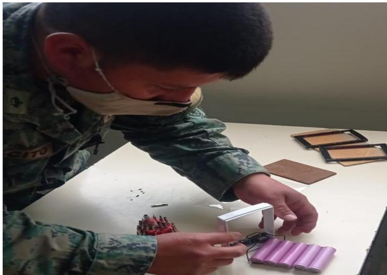
*Nota:* En la siguiente imagen se procede a conectar en paralelo todas las celdas de 18560, para proceder a colocar el módulo de carga en la caja plástica. Tomada de (Job Morales, 2021).
