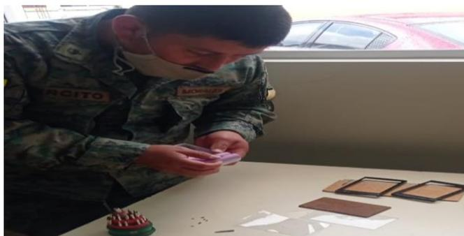
*Nota:* En la siguiente imagen se observa como se realizó el trazo y el corte de los agujeros sobre la caja plástica, para proceder a realizar la conexión del módulo de carga con el banco de celdas. Tomada de (Job Morales, 2021).
