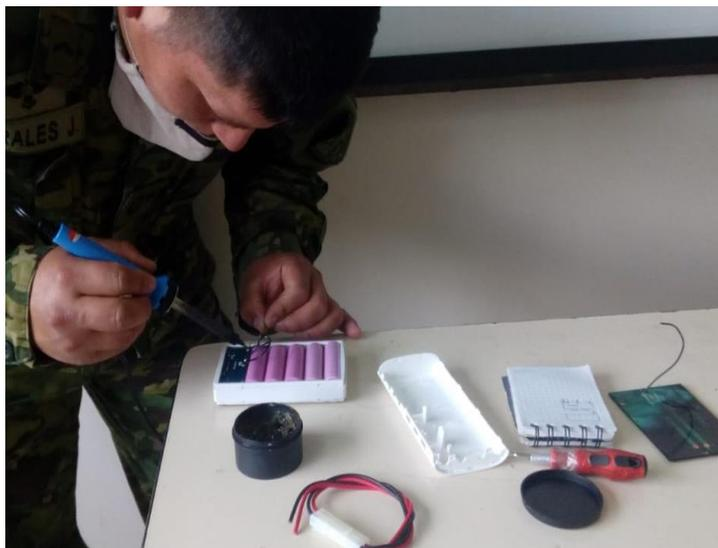
*Nota:* En la siguiente imagen se puede observar la conexión de polaridades del módulo de carga, para proceder a comprobar el funcionamiento correcto del power bank de 30.000 mAh. Tomada de (Job Morales, 2021).
