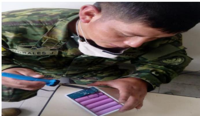
*Nota:* En la siguiente imagen se pudo observar un módulo de carga que consta de 1 entrada USB-C de 2.1 A y 2 salidas USB, una de 1A de 5V y otra de 2.1A de 5V.
