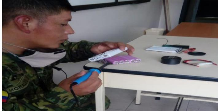
*Nota:* En la siguiente imagen se procede a elegir dos cables gemelos de 1mm de diámetro, para proceder a conectar el módulo de carga. Tomada de (Job Morales, 2021).
