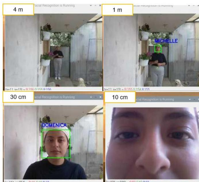
*Nota:* La figura muestra las distancias de prueba que se realizó para llegar a una distancia optima de 30 cm.
