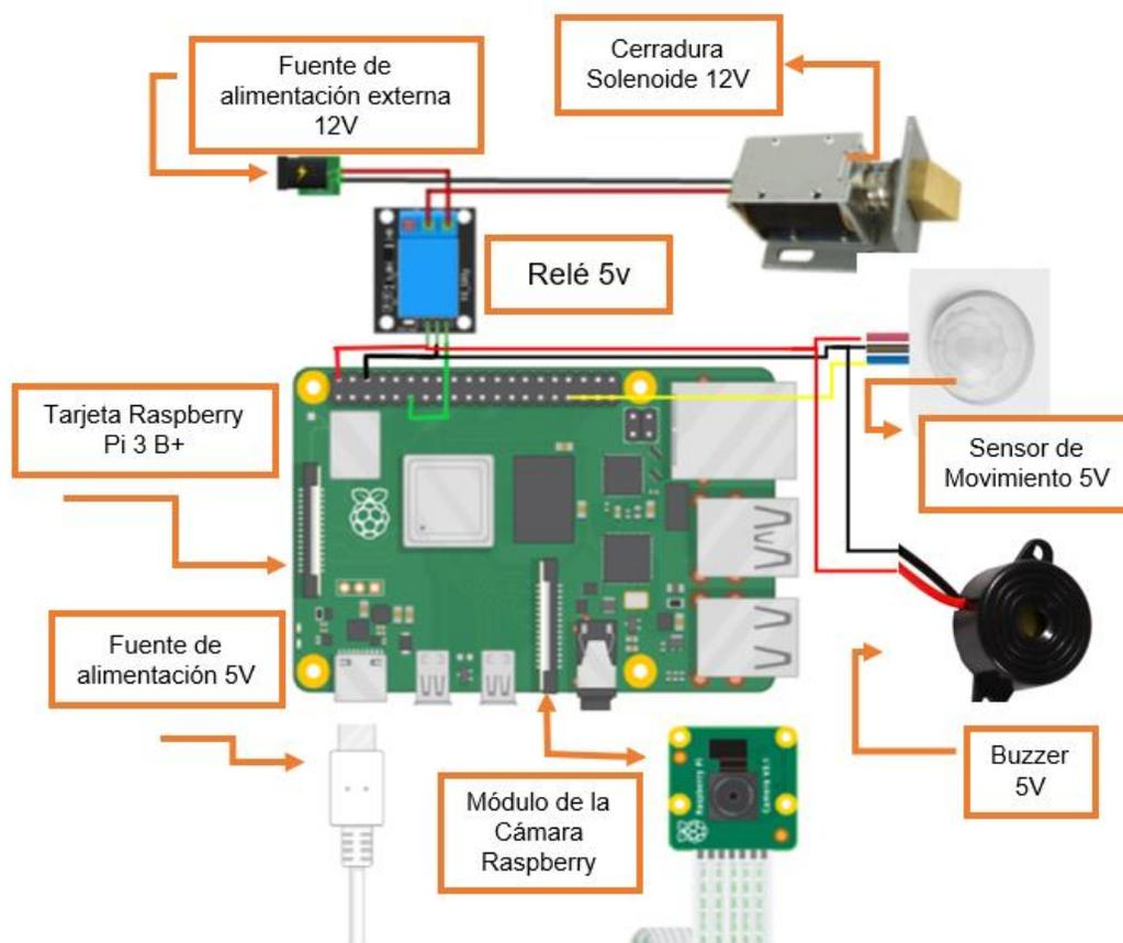
*Nota:* Los elementos ocupados son compatibles con la tarjeta de desarrollo Raspberry Pi y se alimentan de una fuente de 5V para la tarjeta Raspberry y 12V para la cerradura solenoide, el resto de elementos se alimentan desde los puertos GPIO de 5V.
