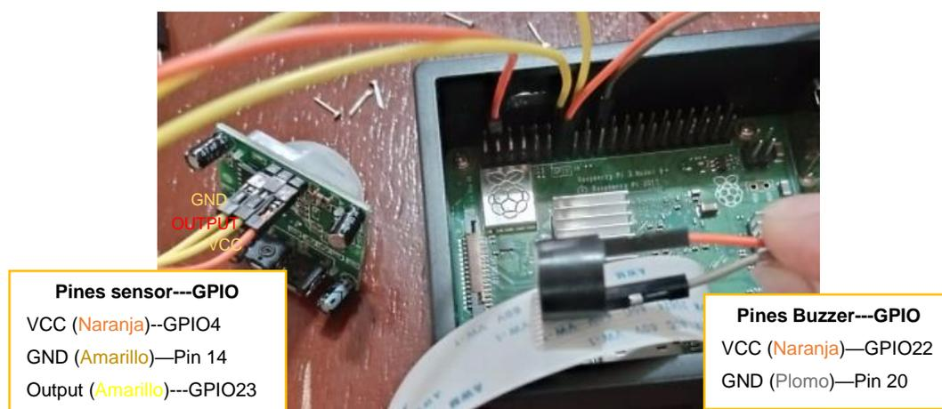
*Nota:* La figura muestra la conexión con los pines GPIO al Buzzer y al sensor PIR.
