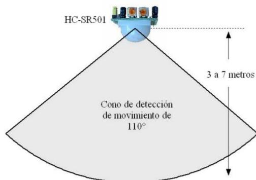
*Nota:* La figura muestra el rango y ángulo en que trabaja el sensor PIR. (Manual de usuario sensor de movimiento PIR, 2017)
