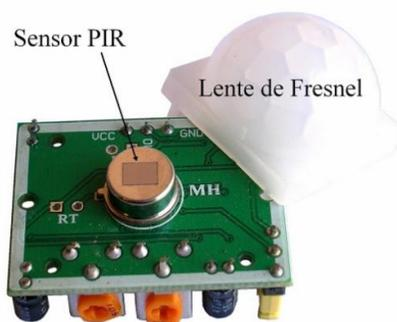
*Nota:* La figura muestra dos elementos principales que conforma el sensor PIR para la detección de movimiento. (Manual de usuario Sensor de movimiento PIR, 2017)
