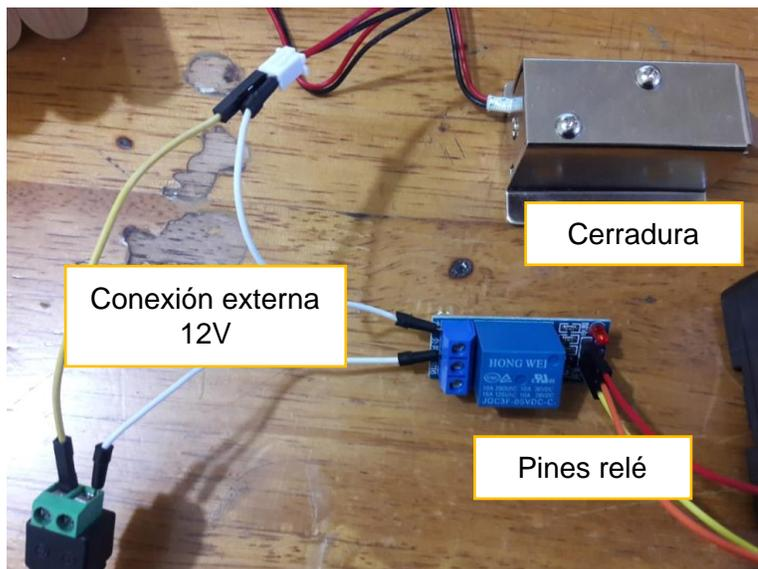
*Nota:* La figura muestra la conexión realizada con el relé, la cerradura y la fuente de alimentación de 12V.
