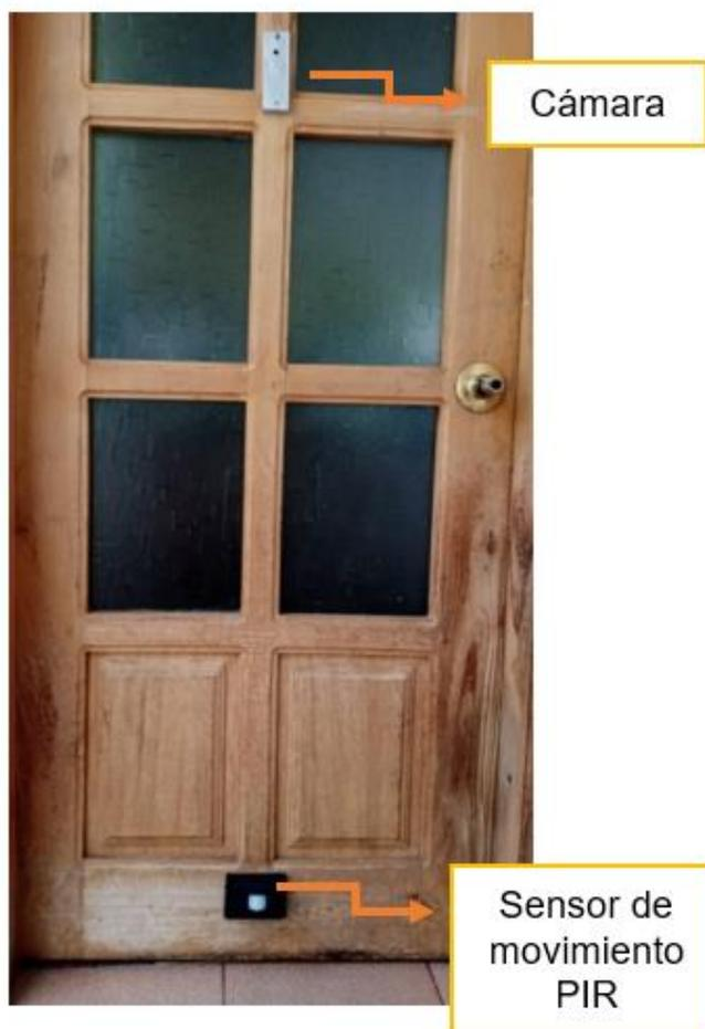
*Nota:* La figura muestra la ubicación del sensor PIR para la detección de movimiento hasta 4 metros del sensor.
