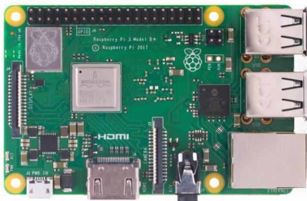
Nota: La imagen muestra la tarjeta física de la Raspberry Pi 3 B+. (Datasheet Raspberry Pi 3, 2020).
