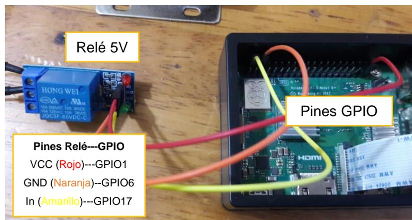
Nota: La imagen muestra la conexión de los pines GPIO de la tarjeta con el relé.
