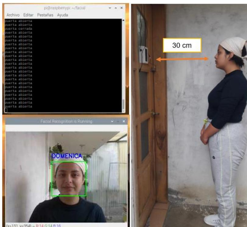
*Nota:* La figura muestra la identificación del usuario a una distancia óptima de 30 cm.
