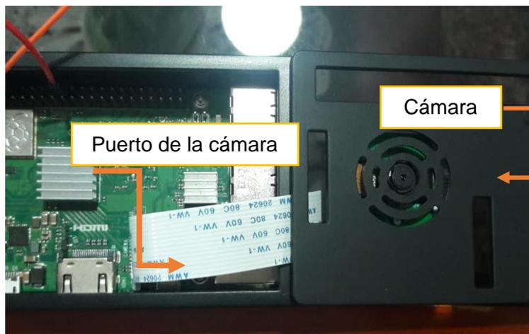
Nota: La figura muestra la conexión del módulo de la cámara en la tarjeta Raspberry Pi.
