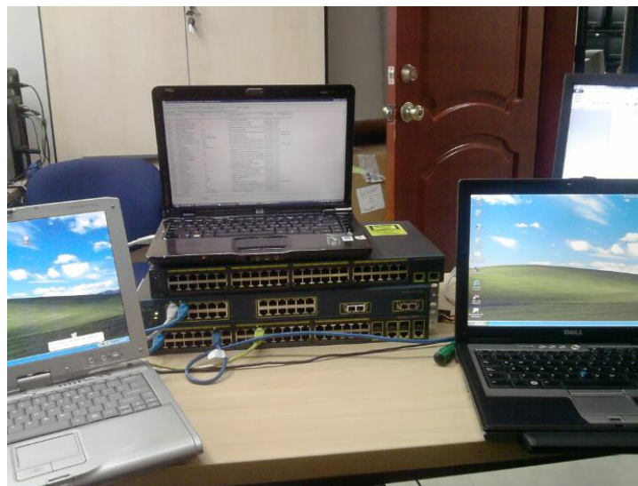
Figura 4.25. Equipos para detección de equipos utilizando dos Switch y un Core CISCO
