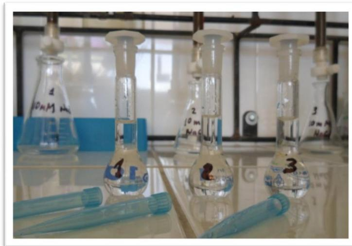
Figura 2. 13 Evaluación del desempeño de los nanodendímeros con aplicación de potencial iónico de 10 mM de NaCl por triplicado.
