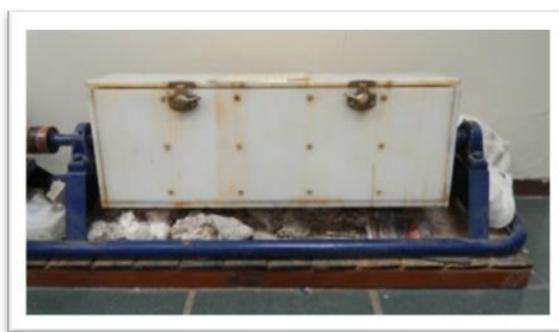
Figura 2. 4 Agitador rotativo donde se realiza la contaminación artificial y la digestión ácida.
