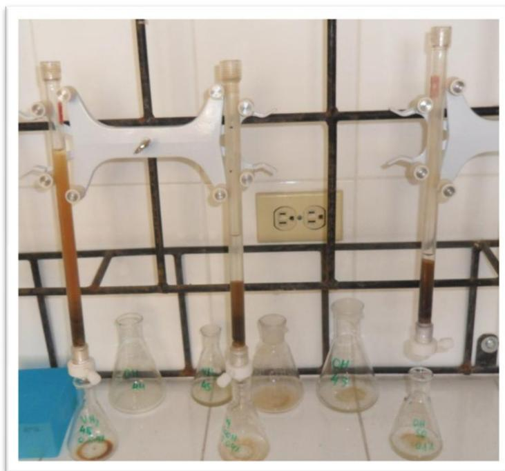
Figura 2. 12 Soluciones de nanodendímeros regenerados en contacto con el suelo contaminado con 200 ppm de cada metal.
