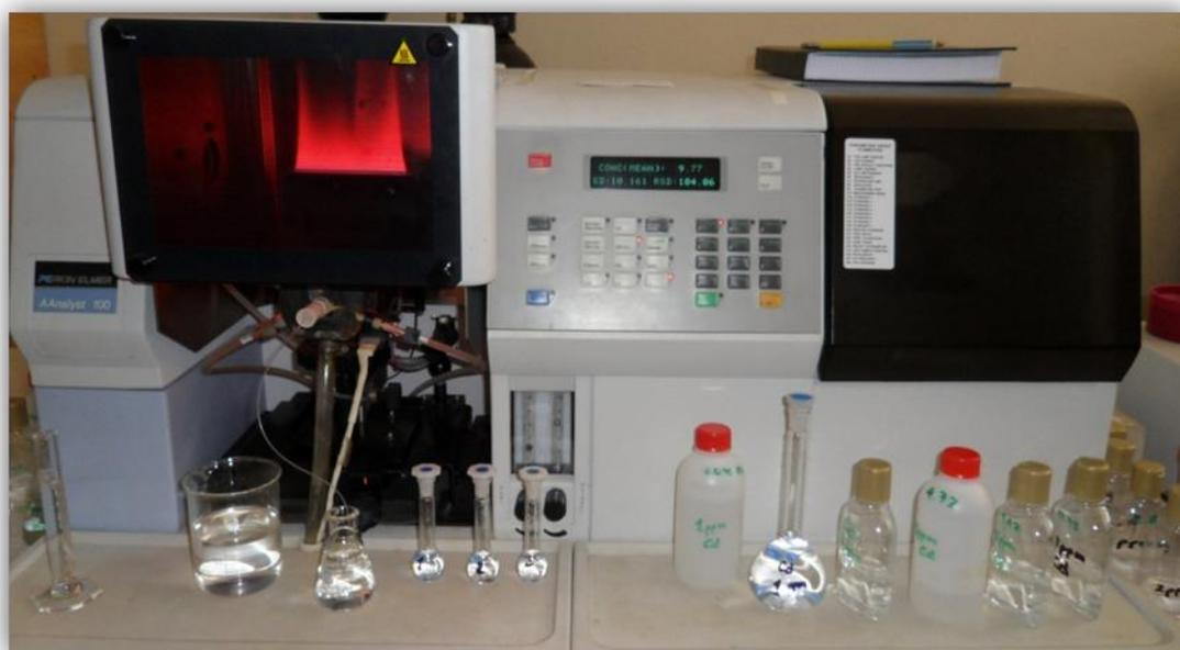
Figura 2. 8 Cuantificación de la concentración de magnesio mediante espectrofotometría de absorción atómica. PERKIN ELMER modelo Analyst 100
