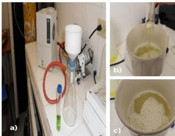
Figura 2. 10 Activación de la resina DOW 3N. a) Bomba de vacío. b) Filtración c) Secado
