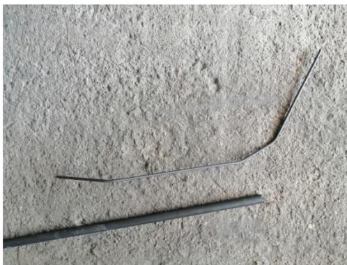
En la siguiente fase se mide los tubos y se cortan a la medida para proceder al doblado correspondiente. Se procede al doblado en frío, ya que el material no requiere algún tipo de calentamiento para el doblado de la geometría del tubo. Se señala un punto para el inicio del
