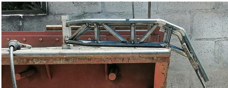
Para completar el bastidor se coloca una placa en la parte superior con la finalidad de que se suelde la placa para la colocación de un tubo que servirá de apoyo para la colocación de las bases del motor, para el basculante se sobrepone al costado un pedazo de tubo y se lo suelda con la finalidad de obtener las medidas establecidas para la colocación del bastidor.
