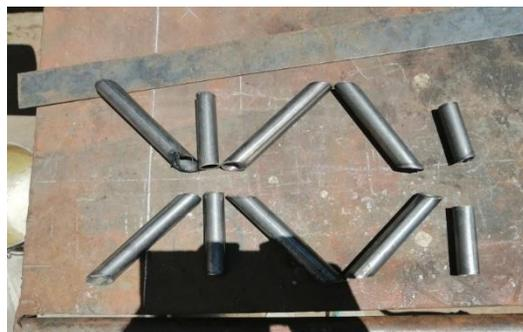
La colocación de los tubos de triangulación debe realizarse con sumo cuidado ya que si se los coloca de manera errónea no podrá cumplir su función y los efectos que puede causar al bastidor pueden ser graves llegando a superar la tolerancia del material y fracturándolo.
