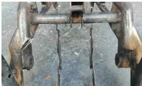
Para el refuerzo del basculante y la unión de los dos brazos se colocó una biga de acero negro de 3mm en forma de "H" el cual tiene como función unir los brazos del basculante y actuar como refuerzo de doble viga para la ubicación del amortiguador trasero se coloca una
