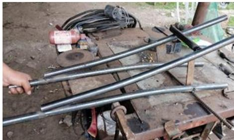
Para la parte inicial de las estructuras se sueldan dos placas cortas simétricamente para que al momento de colocarlas y soldarlas queden perfectamente iguales y simétricas a la vista, esta placa tiene como función ayudar al subchasis a resistir la carga que el conductor genera para así evitar deformaciones en el subchasis.
