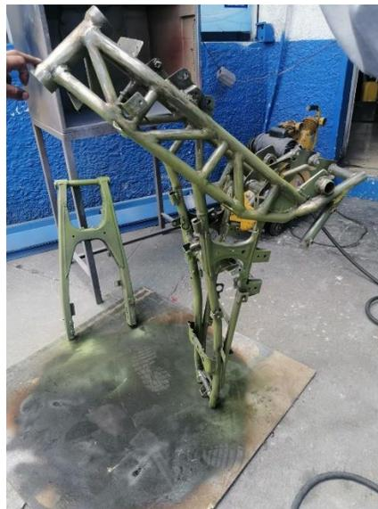
Ya teniendo toda la estructura fondeada se deja secar y se prepara la pintura que se estableció. La pintura que se escogió es color plateado (mate) con tonalidad un poco oscura.
