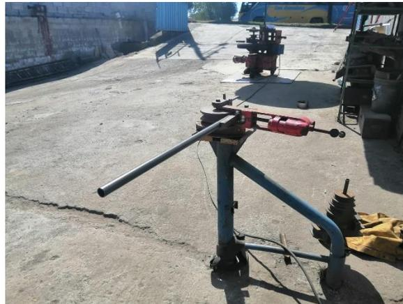
Se doblan los tubos a pulso, es decir con fuerza manual para así obtener el doblado deseado y evitar algún tipo de defecto que se puede presentar durante el procedimiento. Se procede a revisar que el doblez este correcto y se procede a cortar las otras partes de los tubos para proceder a su soldadura.
