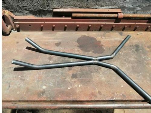
Posteriormente se procede a colocar los tubos para dar la forma del chasis que se ha seleccionado para este estudio, eso se indica en la figura 41.
