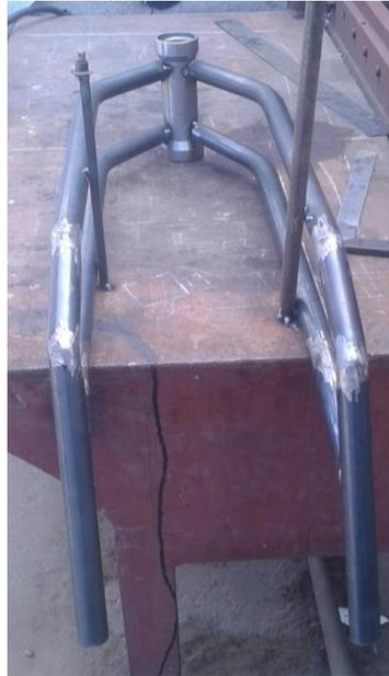
A continuación, se prepara los tubos correspondientes para la triangulación, esta triangulación tiene como finalidad el de ayudar a distribuir las cargas que recibe el bastidor para que puede disminuir la flexión que produce el bastidor durante el manejo.
