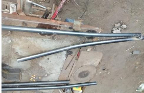
Teniendo lista las dos estructuras se verifica que estén perfectamente iguales, se verifica su rectitud a escuadra, Se realiza un punto de soldadura para revisar que las estructuras estén completamente simétricas.
