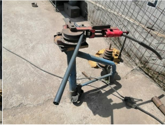
Posición del tubo en la matriz para doblar
