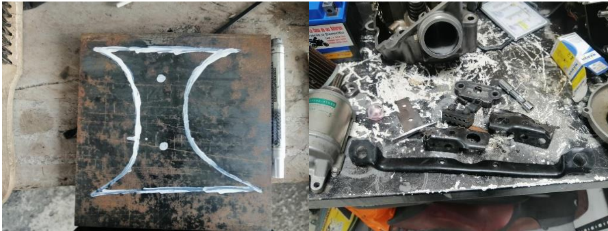
Placas de refuerzo para el subchasis y Platinas de anclaje al subchasis
