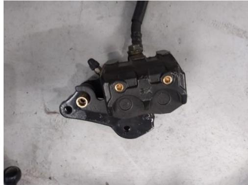
Seguido de acoplar la bomba de freno a la mordaza delantera, por ello se necesitó un playo de presión para asegurar que el líquido de frenos no llegue a ser desperdiciado.
