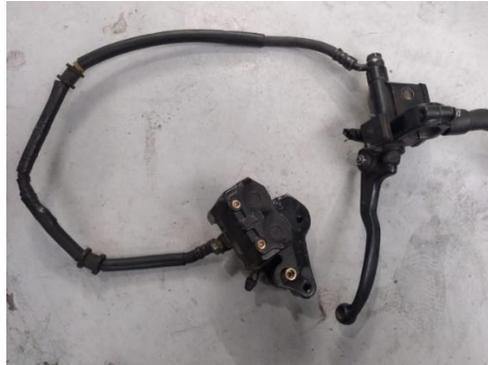
Finalmente se incorporan todos los complementos del sistema de frenado de la parte delantera. Para posteriormente realizar una purga de aire del sistema para un mayor agarre entre la pastilla y el disco de freno.
