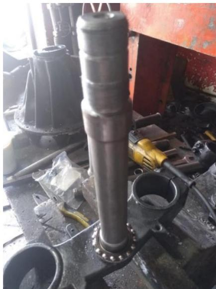
Se deben incorporar los rodamientos para permitir el giro adecuado de la dirección de la moto.
