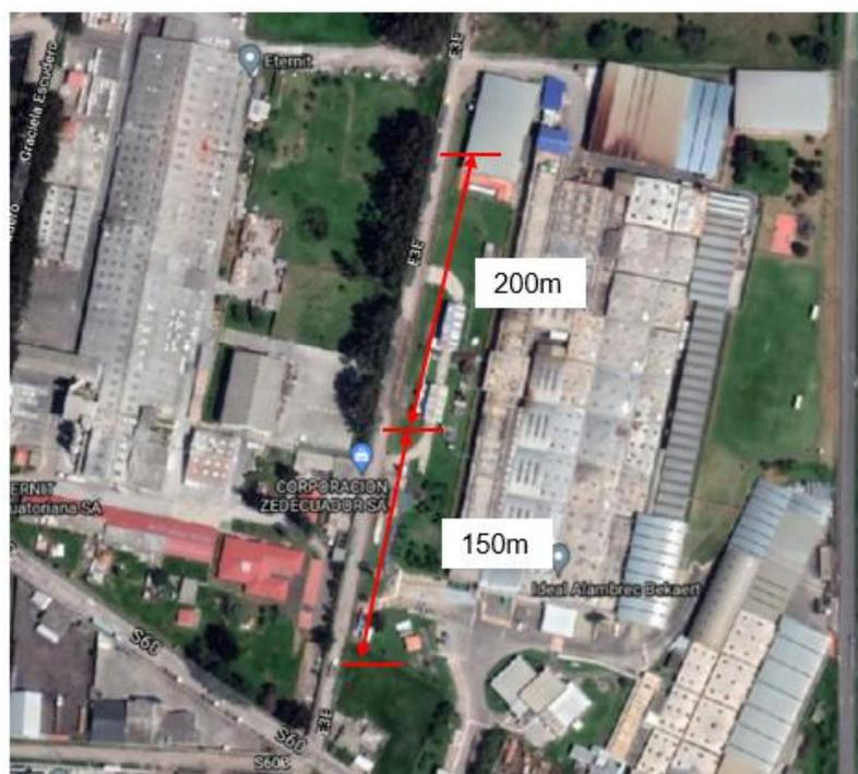
En la siguiente imagen se muestra el piloto realizando la prueba de distancia de frenado, iniciando desde el punto de partida hasta llegar a la distancia de 200m donde instantáneamente el piloto accionará el freno, y tendrá que frenar en la distancia mínima posible.
