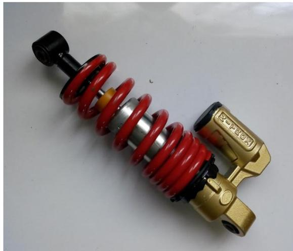
Finalmente se hace la incorporación del sistema de suspensión (delantero y trasero). Para este proceso se debe tener en cuenta la regulación del perno ajuste de las barras ya que es primordial para la maniobrabilidad. Por ello se realiza un ajuste a pulso verificando que no quede muy apretado.
