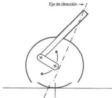
*Nota.* Eje de dirección del sistema por rueda tirada. Tomado de ( Vilaplana Ragüés, 2015)
