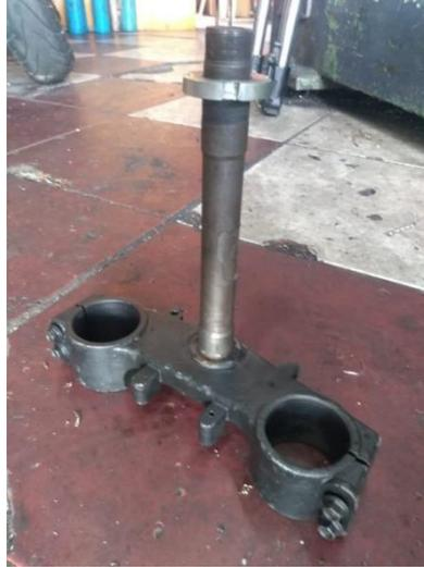
Se vio la necesidad de adoptar los rodamientos originales. Donde en la parte inferior consta de un retén de bolas y una pista inferior de 29,91mm de diámetro interno, además, de la parte superior con un retén de bolas y una pista superior, con un diámetro interno de 29.9mm.
