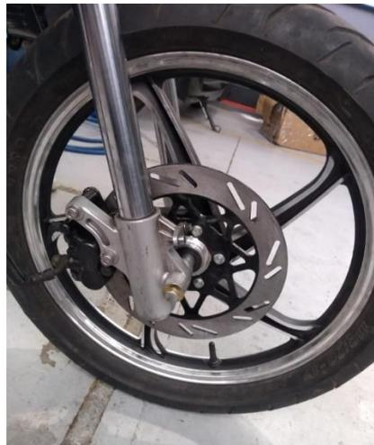
Para la incorporación del sistema de frenado posterior se implementó un sistema totalmente eficiente, como lo son la mordaza y el disco de freno, conjuntamente con la palanca de freno y el depósito del líquido.
