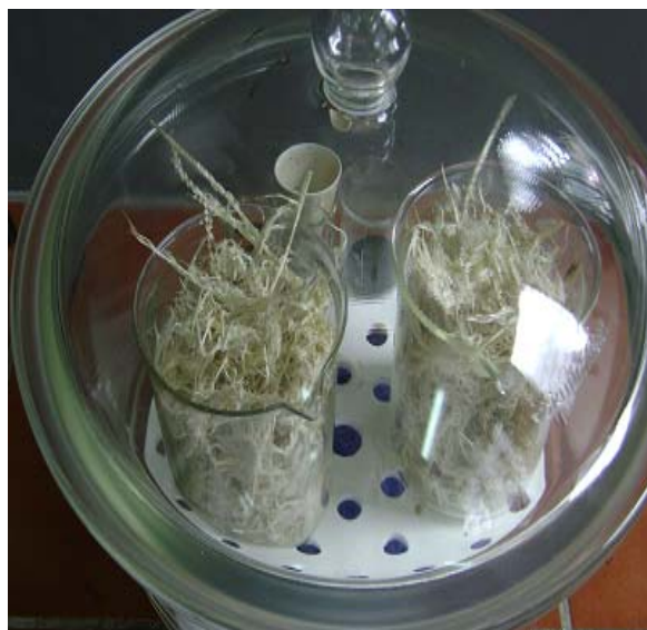
Figura 2.2 Desecador Duran Vakuumfest.
