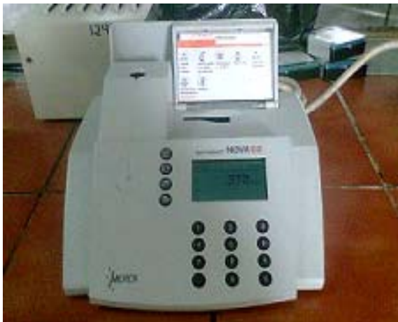
Figura 2.9 Lector de DQO Spectroquant Nova 60 Merck.
