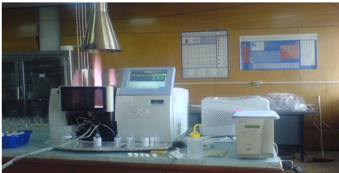
Figura 2.11 Espectrofotómetro de Absorción Atómica Perkin Elmer AAAnalyst 200.
