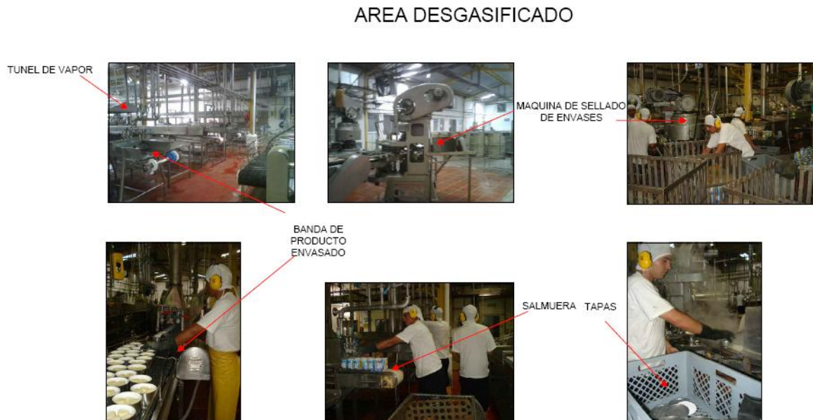
Figura. 2. 7. Área de desgasificado y sellado
