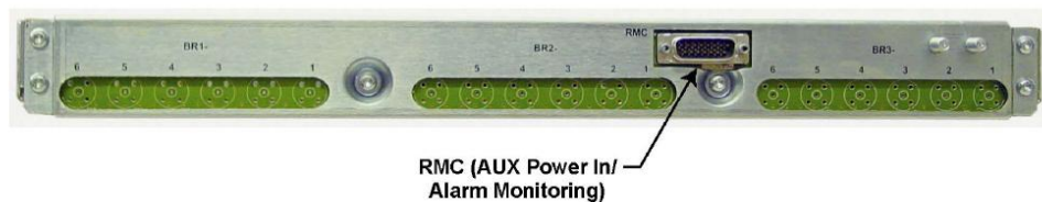
Figura. 3.34. Bandeja RMC del Sitio GTR 8000 (Vista Posterior)
