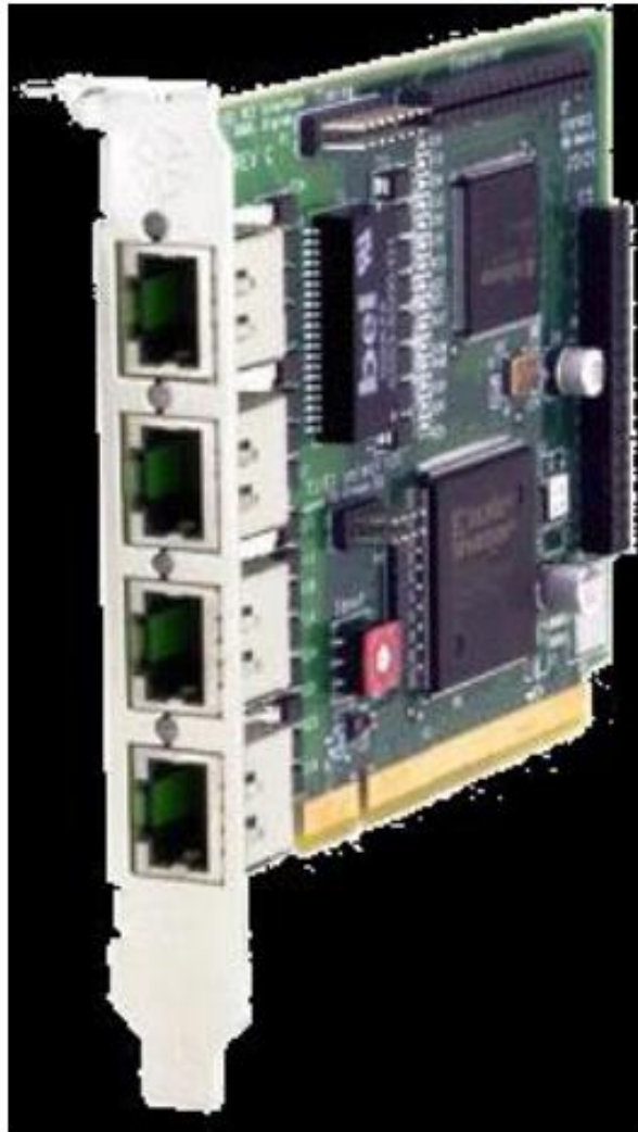
Figura 2. 13. Tarjeta TE210P DIGIUM 4 primarios
