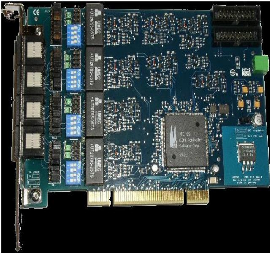
Figura 2. 10. Tarjeta OCROBRI JUNGHANNS 8 puertos
