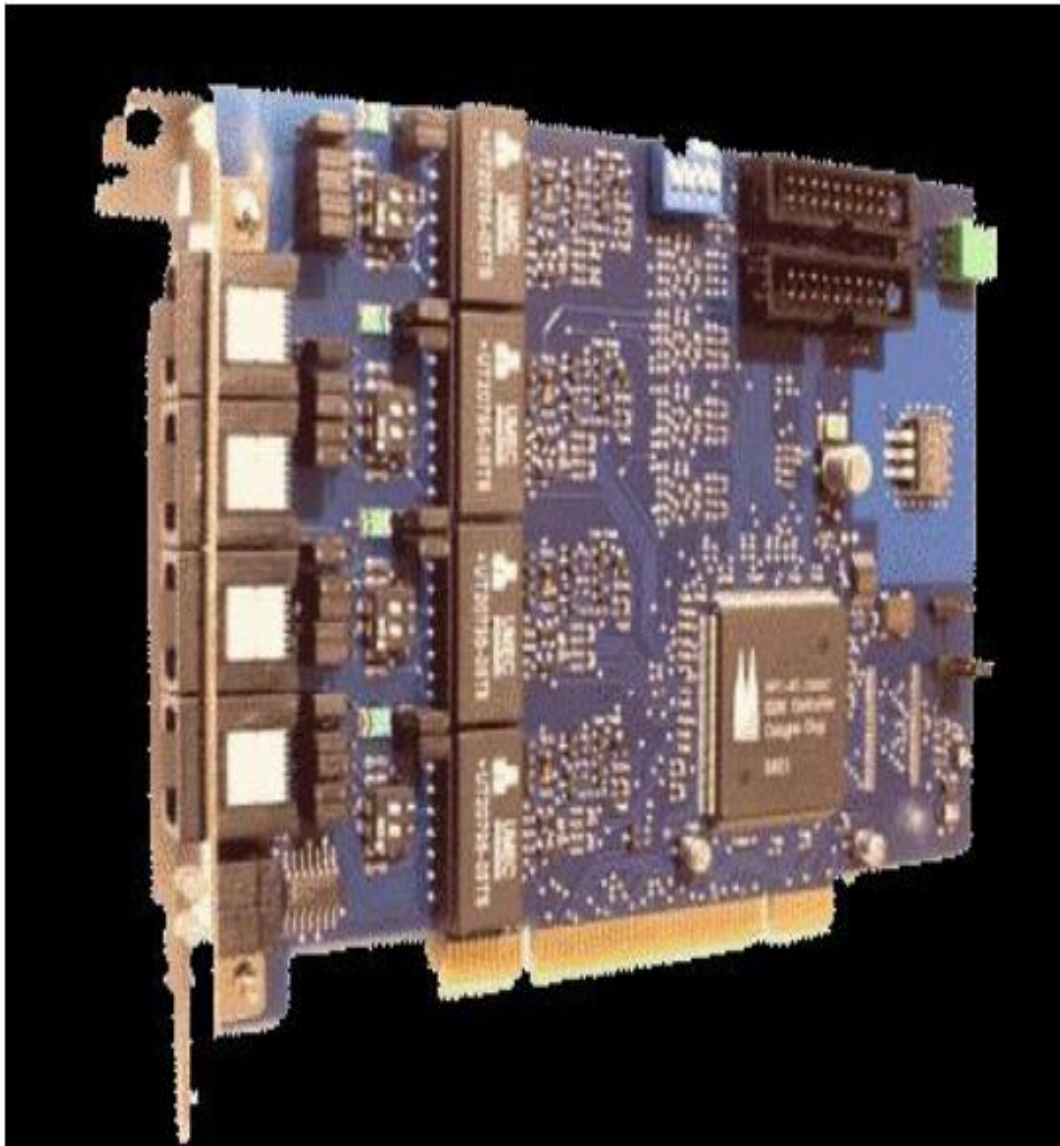
Figura 2. 9. Tarjeta QUADBRI JUNGHANNS 4 puertos
