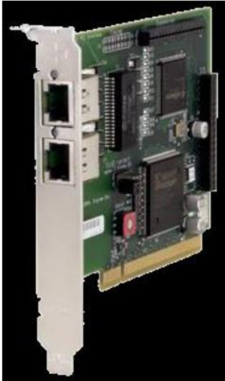
Figura 2. 12. Tarjeta TE210P DIGIUM 2 primarios
