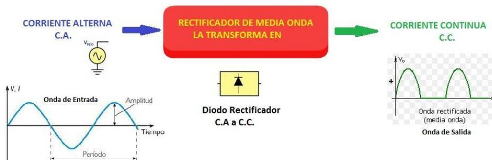
*Nota.* La figura muestra el circuito de un convertidor monofásico de media onda y las formas de onda ideales de entrada y salida. Tomado de (Rashid, 2020)
