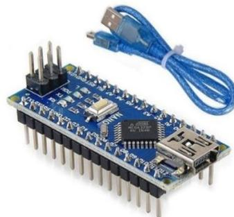
*Nota.* La figura muestra la forma física del Arduino Nano. Tomado de (*Electronica, 2020*)
