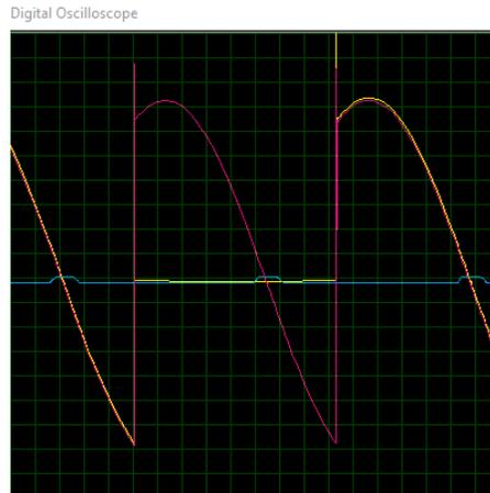
*Nota. En la figura se muestra la forma de onda con un ángulo de disparo de 120° voltaje de salida (magenta), pulso (azul), entrada (amarillo).*
