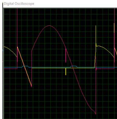
*Nota. En la figura se muestra la forma de onda con un ángulo de disparo de  $0^\circ$  voltaje de salida (magenta), pulso (azul), entrada (amarillo).*
