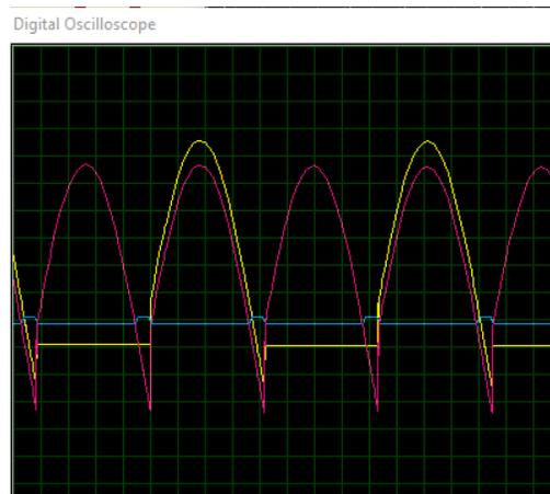
*Nota. En la figura se muestra la forma de onda con un ángulo de disparo de 180° voltaje de salida (magenta), pulso (azul), entrada (amarillo).*
