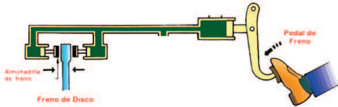
Fig. 2.7. Funcionamiento del Freno Mecánico.
