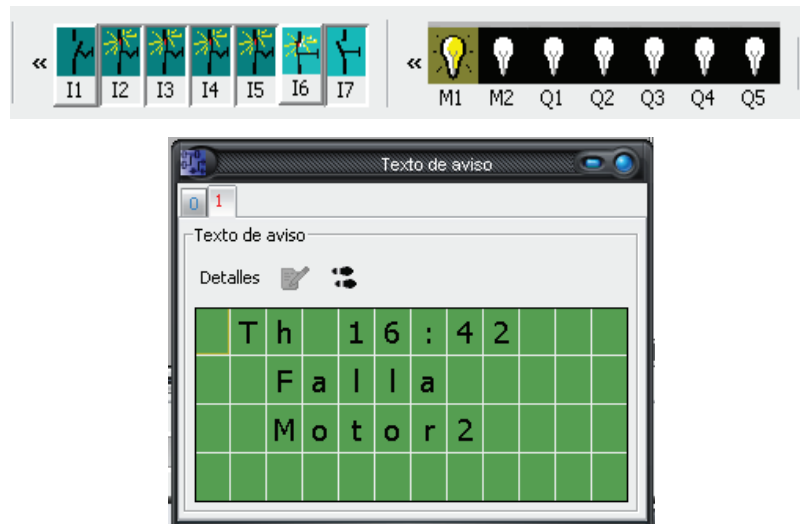
Fig. 3.44. Simulación cuando se acciona I7 se produce falla en motor2
