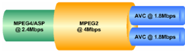
Figura. 2.5. Comparación de las tasas de compresión
