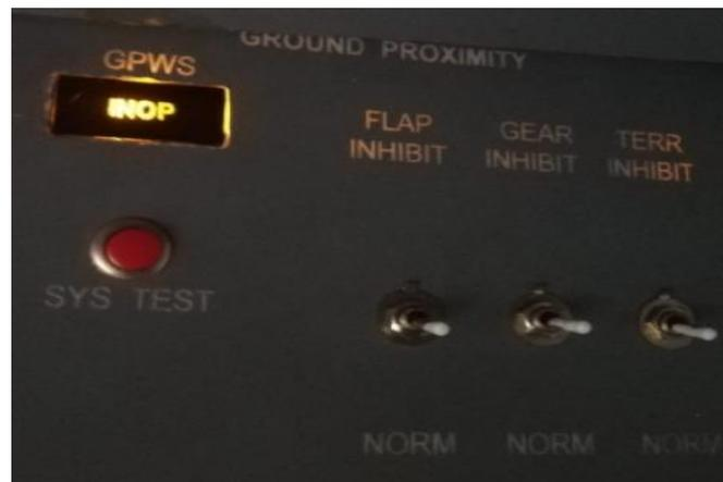
*Nota:* La figura muestra el sistema GPWS funcionando y con el indicador visual (Luz INOP) cumpliendo su función.
