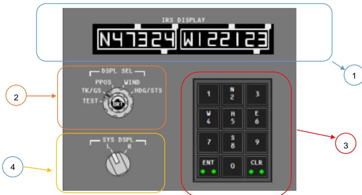
*Nota:* La imagen muestra los componentes que componen el ISDU. Tomado de (Theoryce, Slideshare, 2013).
