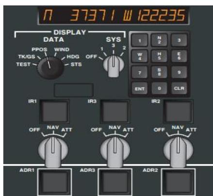
*Nota:* La figura muestra los componentes del panel del sistema de referencia inercial.
