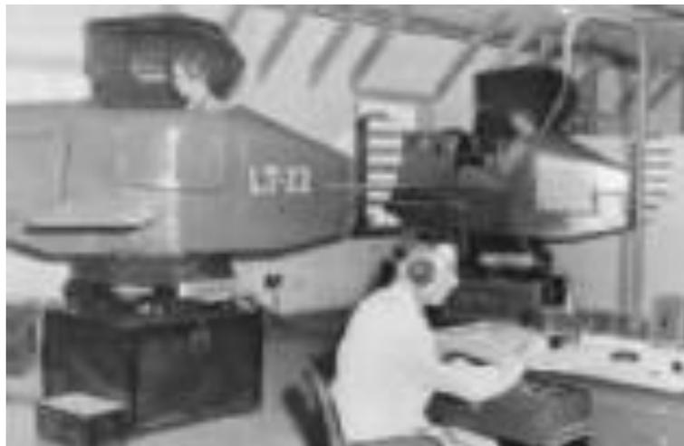
*Nota:* La figura permite observar uno de los simuladores que empezaban a emular los movimientos con dispositivos electromecánicos. Tomado de (Page, 2000).
