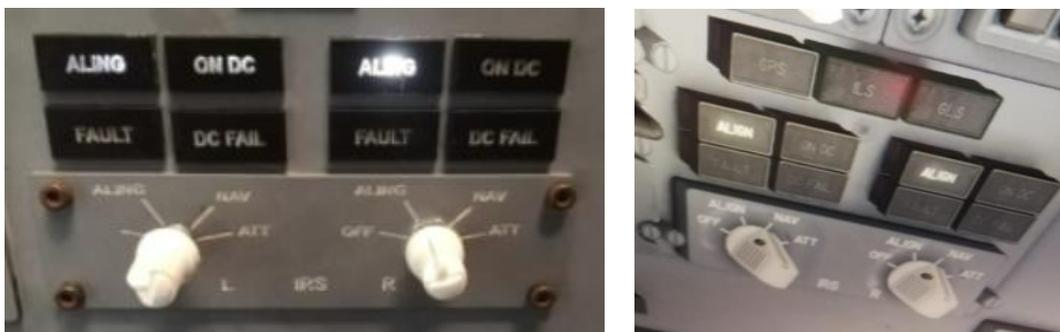
*Nota:* La figura muestra los selectores del IRS en modo NAV tanto en físico como en software.
