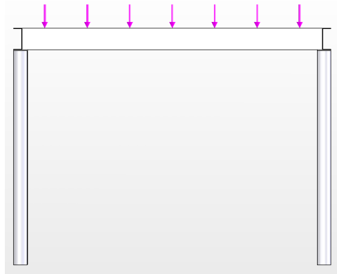
Figura 4-28: Cargas en la estructura principal
