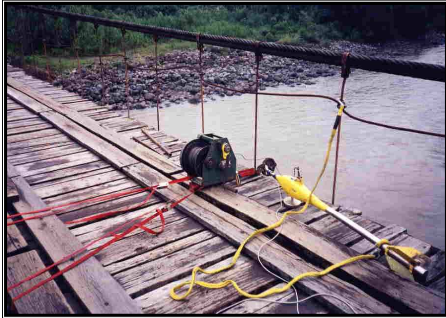
Foto 3.5. Equipo y materiales para aforo con molinete
