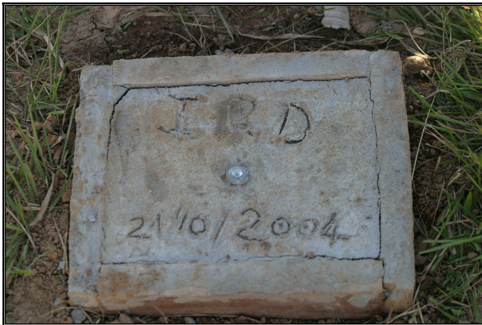
Figura. 6.13 Pedestal de precisión de una estación, el clavo materializa el punto geodésico de las coordenadas conocidas.
