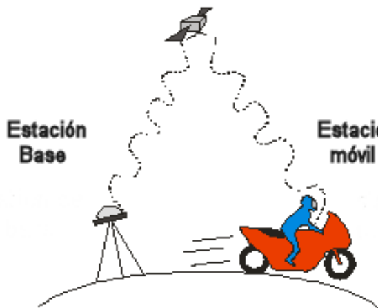
Figura. 6.10 a satélite en común encima de una estación receptadora GPS y de un receptor móvil.
