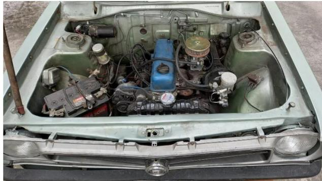
Para poder arrancar el vehículo se cambió bujías, condensador, platino y filtro de gasolina.
