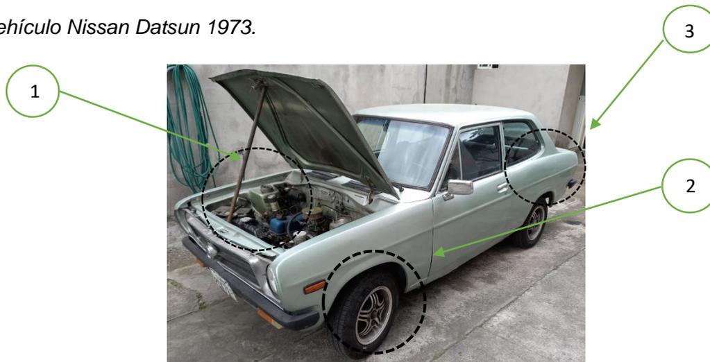
Los sistemas a intervenir son el Sistema de Frenado “2”, ABC de motor de carburador “1” y reparaciones extras que surgieron en la reparación del vehículo en si “3”.
