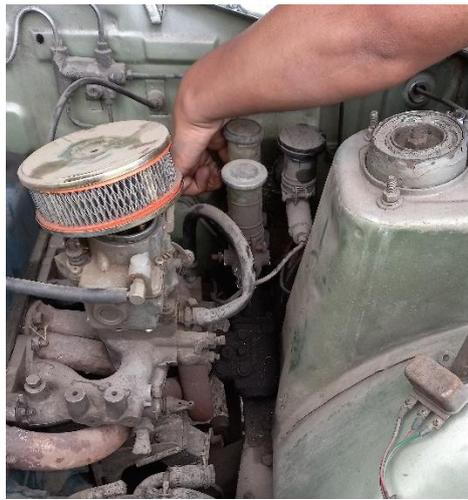
Una vez desmontada la bomba de freno, se procede a tomar medidas para los separadores donde irán instalados el servofreno y bomba.
