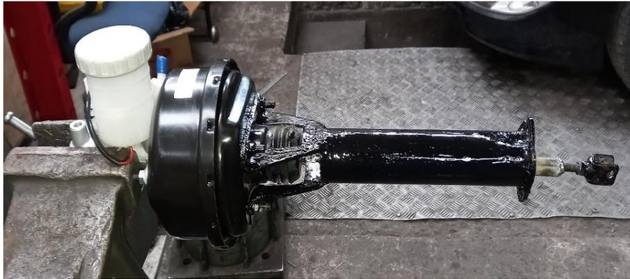
Se procede al montaje y armado del conjunto de servo freno y bomba con sus acoples, además se instaló una platina que va atornillada al motor para que tenga mayor sujeción, por otra parte, para que la realización del mantenimiento sea más fácil todo el sistema instalado es desmontable.
