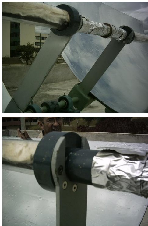
Figura 7.8. Ensamblaje de los absorbedores.
