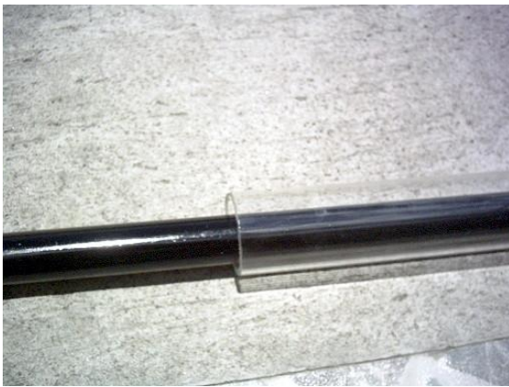
Figura 6.53. Colocación del tubo de cobre dentro del tubo de vidrio.
