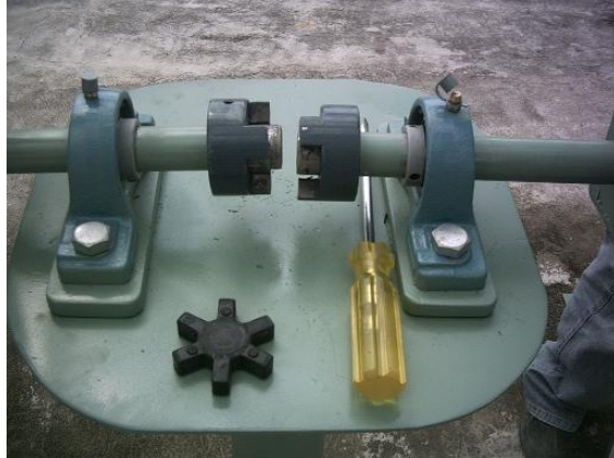
Figura 7.7. Colocación de las chumaceras y acoples flexibles.
