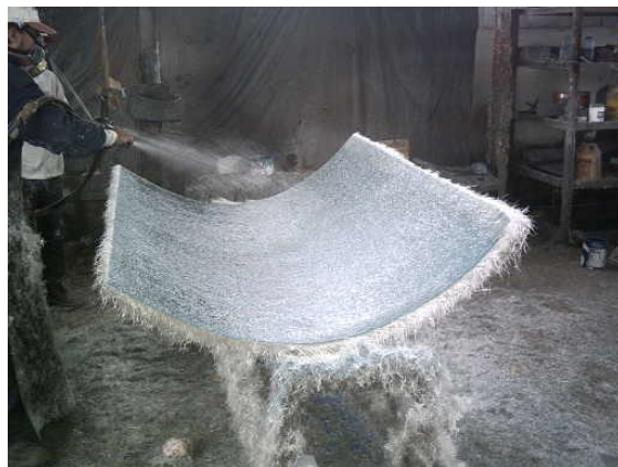
Figura 6.45. Rociado de fibra de vidrio en la superficie interior del concentrador.
