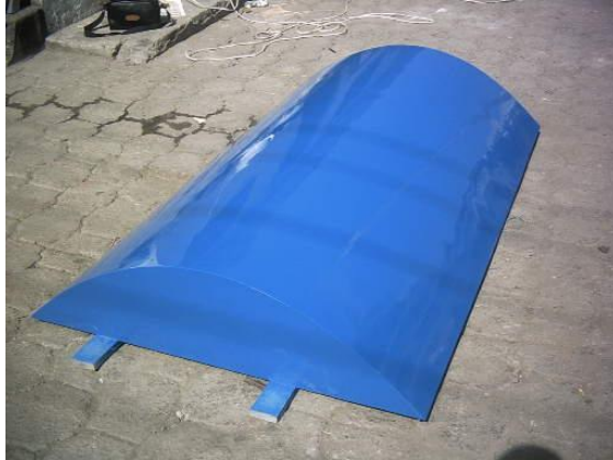
Figura 6.24. Primer molde terminado.
