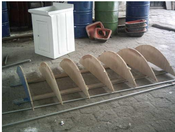
Figura 6.2. Ubicación de las plantillas macho como costillas del primer molde.
