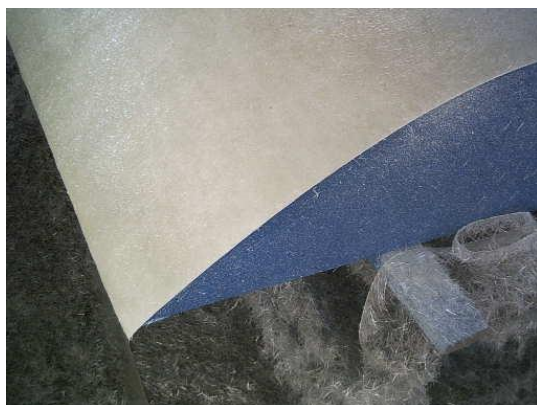
Figura 6.39. Recortes de los bordes de la fibra de vidrio.
