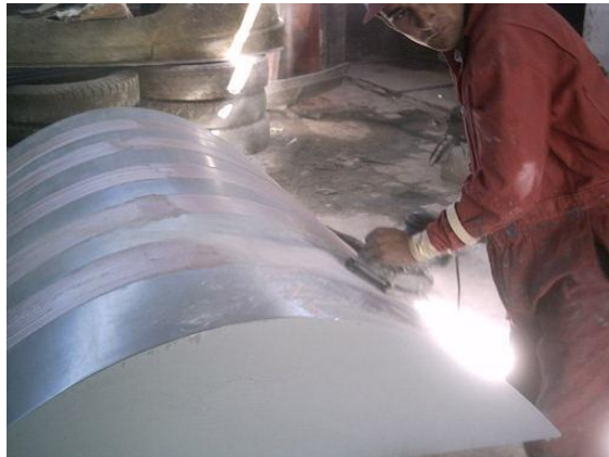
Figura 6.6. Lijado del exceso de masilla en la superficie del molde.
