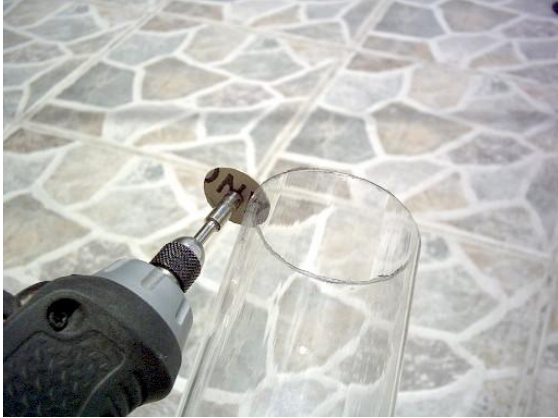
Figura 6.52. Proceso de lijado del tubo de vidrio.
