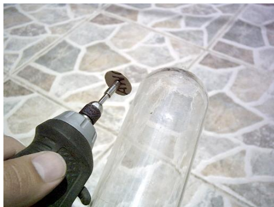
Figura 6.51. Proceso de corte del tubo de vidrio.
