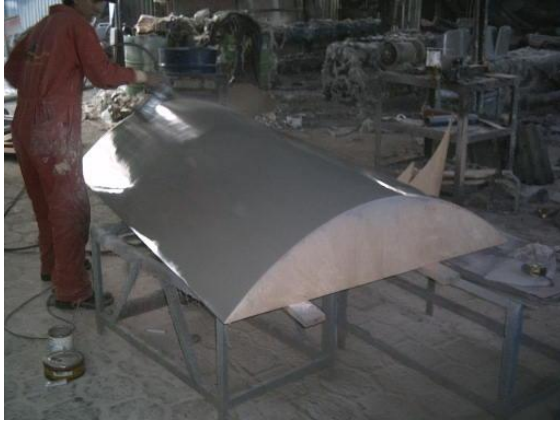
Figura 6.7. Proceso de fondeado de la superficie del molde.
