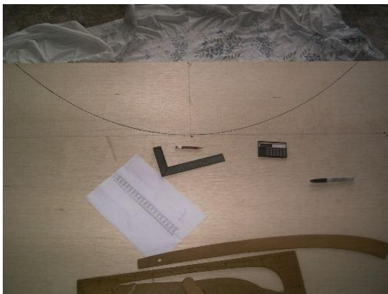
Figura 6.1. Parábola dibujada en tabla triplex.
