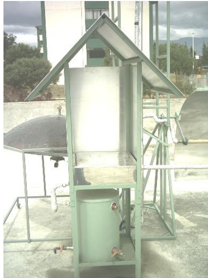
Figura 7.11. Ubicacion y ensamblaje de la caseta de protección, cocina y tanque calentador.
