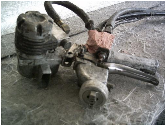
Figura 6.37. Pistola rociadora-mezcladora de fibra de vidrio.
