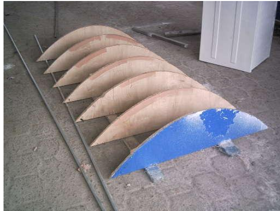
Figura 6.47. Costillas en forma de parábola extraídas del primer molde.
