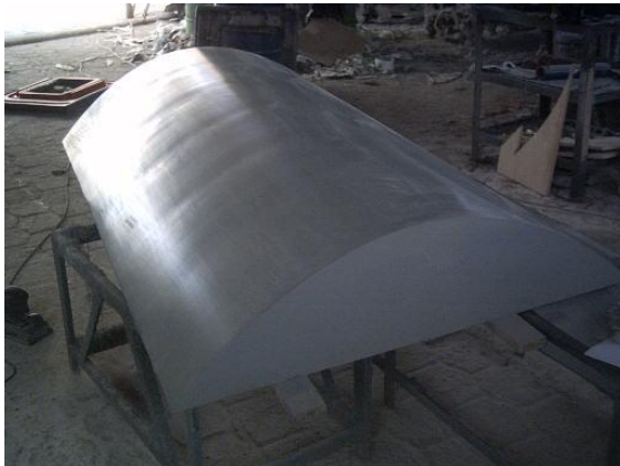
Figura 6.8. Terminación del proceso de fondeado de la superficie.
