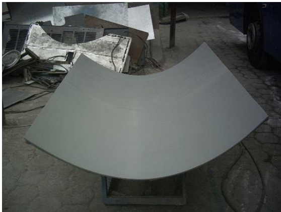
Figura 6.44. Superficie fondeada del primer concentrador.
