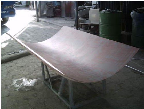
Figura 6.43. Superficie interior del primer concentrador corregida con masilla automotriz para acabados.
