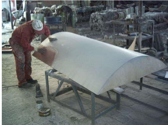
Figura 6.10. Corrección de imperfecciones en la superficie.
