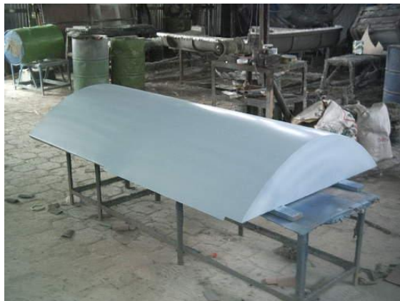
Figura 6.23. Terminación de la corrección de la cavidad.
