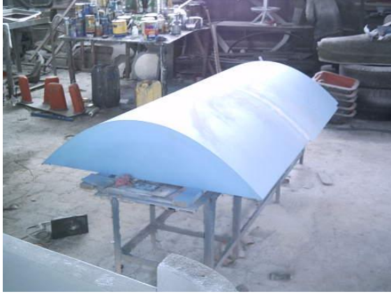
Figura 6.20. Pintado de la superficie luego de colocadas las laminas de aluminio.
