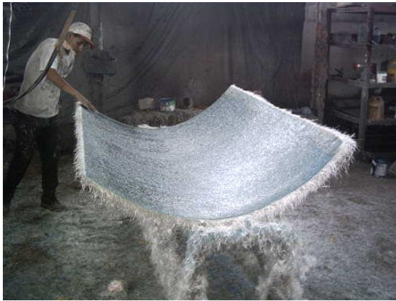
Figura 6.46. Acentamiento de la fibra de vidrio con rodillo.
