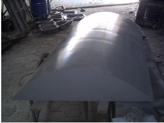
Figura 6.12. Superficie del molde dada la terminación de fondeado.
