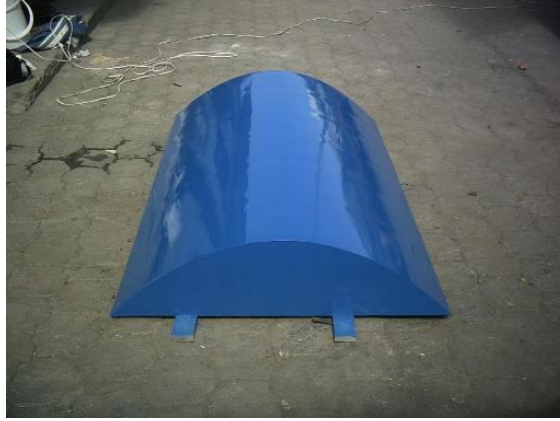
Figura 6.14. Proceso de secado de la pintura en la superficie del molde.
