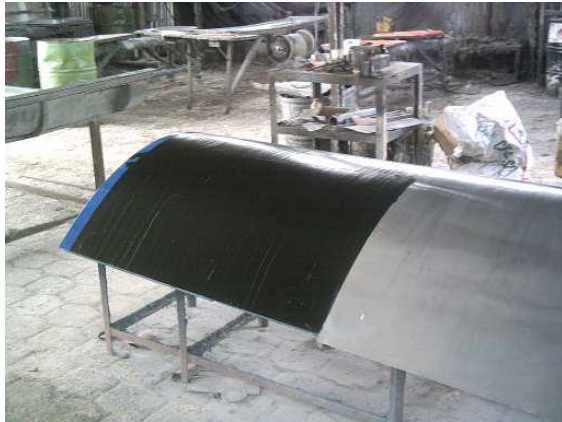
Figura 6.16. Colocación del pegamento sikaflex.
