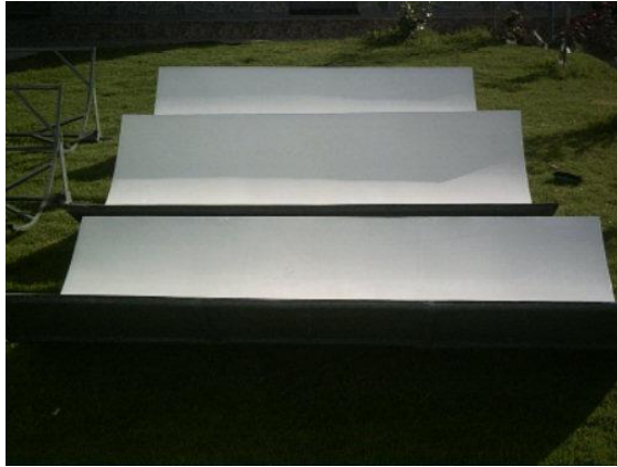
Figura 6.48. Concentradores Cilíndricos Parabólicos.
