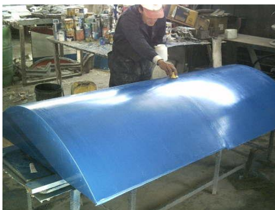
Figura 6.25. Colocación de la cera cauba.
