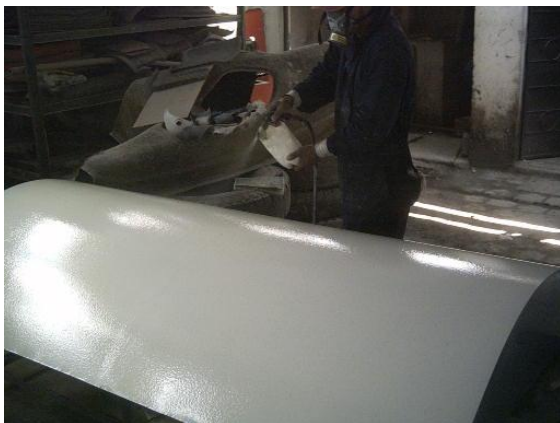
Figura 6.34. Colocación del Gelco.
