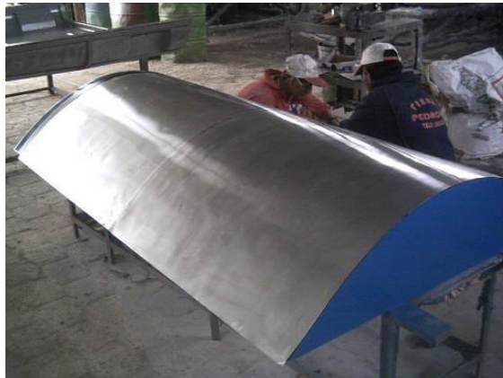
Figura 6.19. Recorte de los excedentes de las láminas de aluminio.
