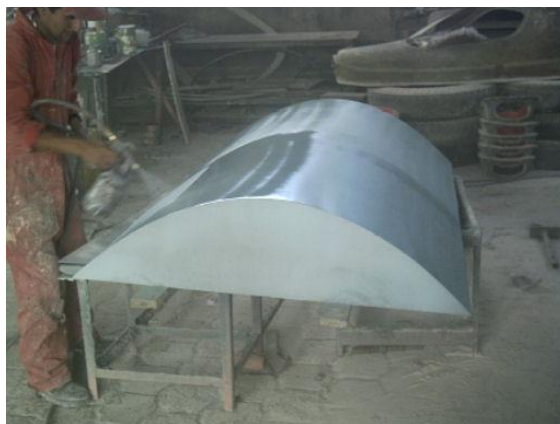
Figura 6.11. Fondeado de la superficie después de corregir imperfecciones.
