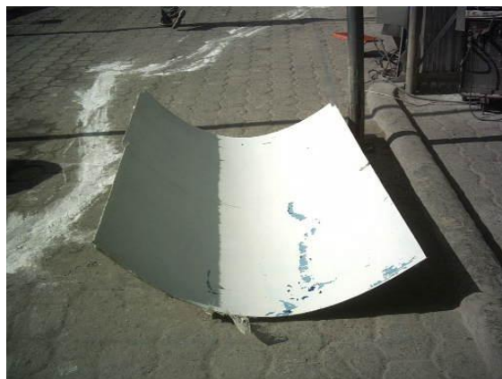
Figura 6.42. Primer concentrador desmoldado.
