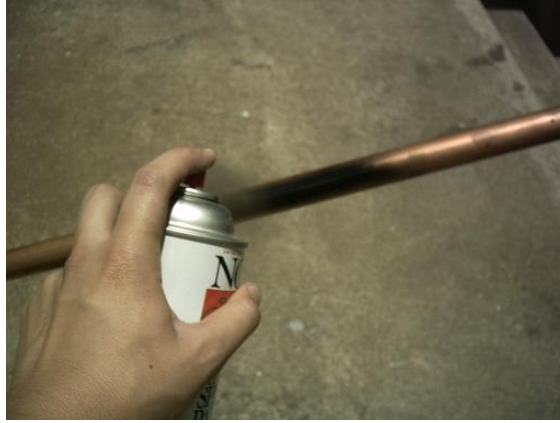
Figura 6.50. Proceso de pintura del tubo de cobre.
