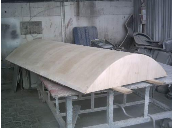
Figura 6.3. Colocación del aglomerado encima de las costillas.
