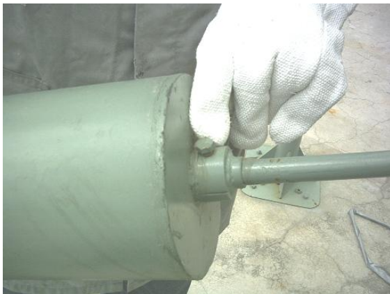
Figura 7.19. Desplazamiento del soporte para contrapeso.
